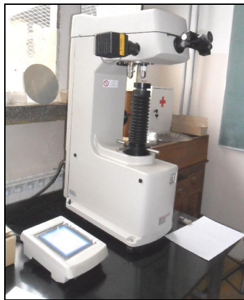
Slika 3.5. Ispitivanje tvrdoće metodom prema Vickersu
