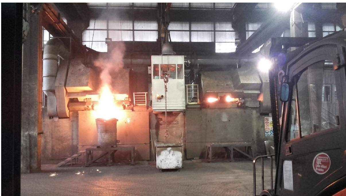
Slika 3.1. Ispust taline sivog lijeva iz srednje-frekventne indukcijske peći
