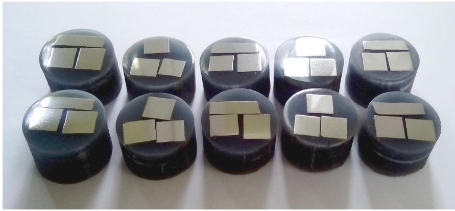
Slika 3.6. Pripremljeni uzorci za metalografsku analizu
