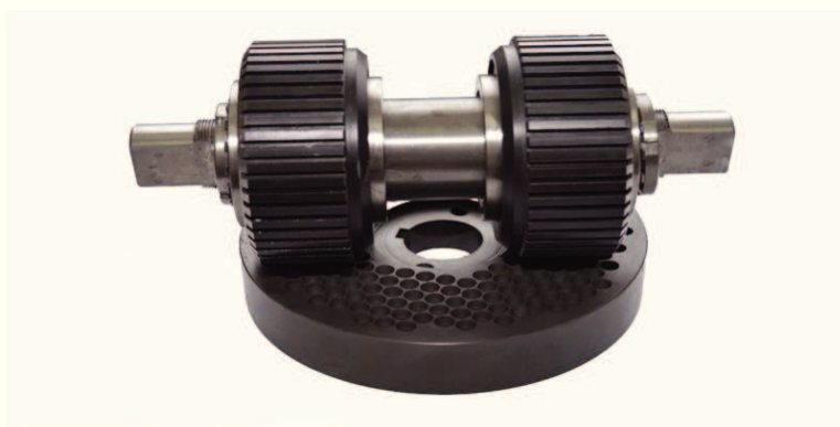
Slika 3. Matrica s valjcima za rolanje i osovinama [5]
