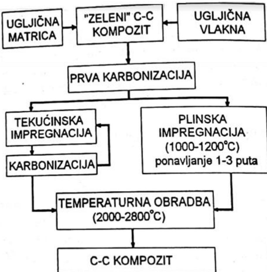
Slika 6. Postupak proizvodnje C – C kompozita [28]
