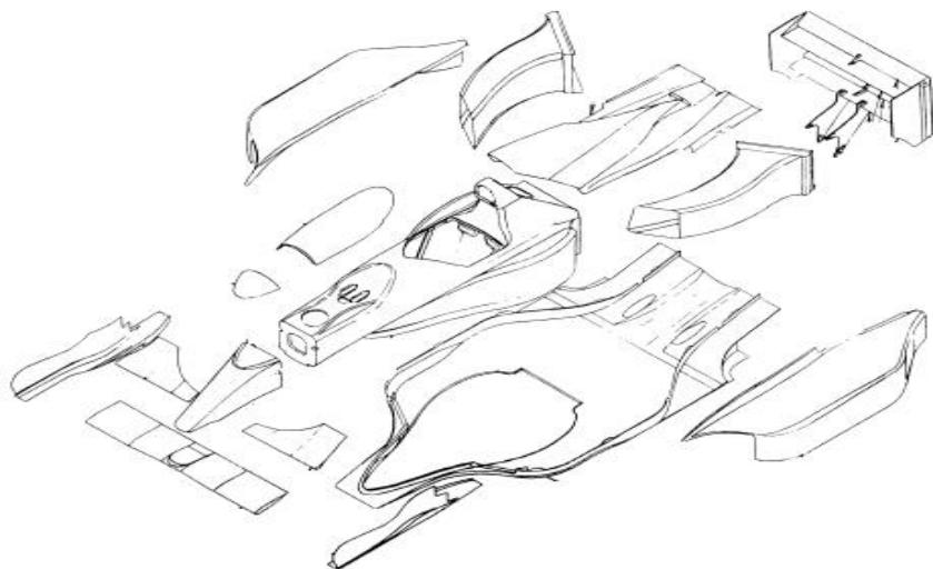
Slika 7. Dijelovi „Formule 1“ od ugljičnih kompozita [27]
