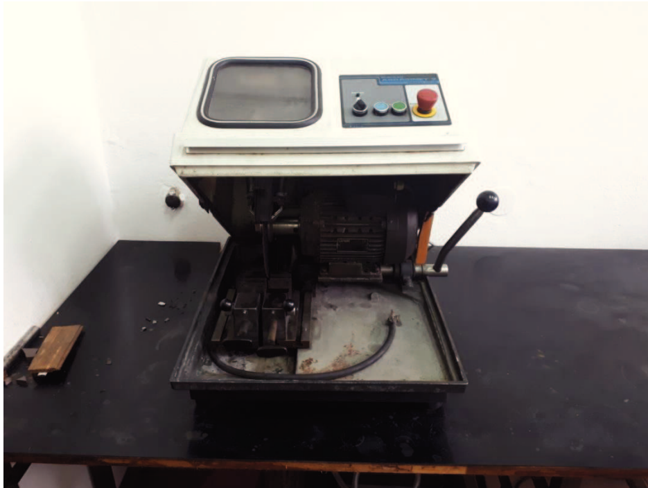
Slika 34. Fotografija uređaja za rezanje uzoraka "Buehler Isomet"
