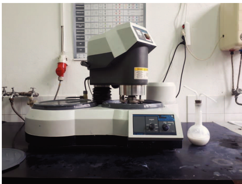
Slika 36. Fotografija uređaja za brušenje i poliranje "Buehler Phoenix Beta"
