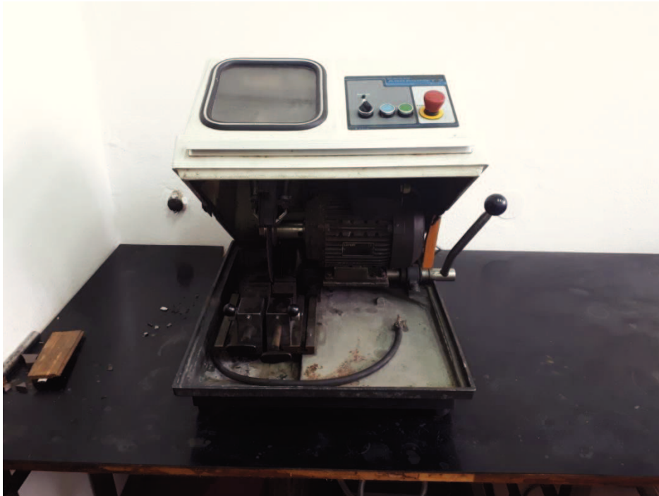
Slika 34. Fotografija uređaja za rezanje uzoraka "Buehler Isomet"
