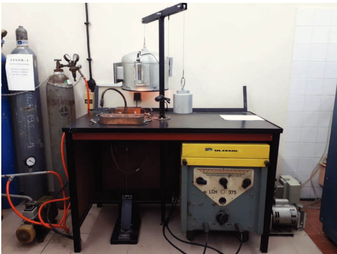
Slika 27. Fotografija laboratorijske vakuumske elektrolučne peći za taljenje i lijevanje uzoraka
