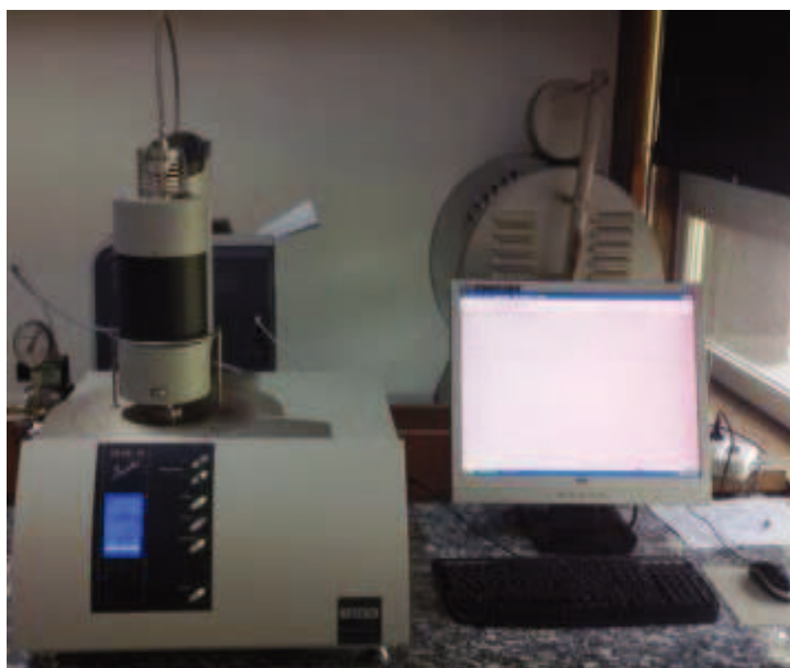
Slika 39. Fotografija uređaja NETZSCH STA Jupiter 449 F1 za DSC toplinsku analizu
