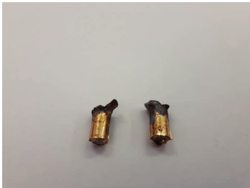
Slika 29. Fotografija uzoraka Cu-Al-Mn-Zn legure proizvedene lijevanjem u bakreni kalup
