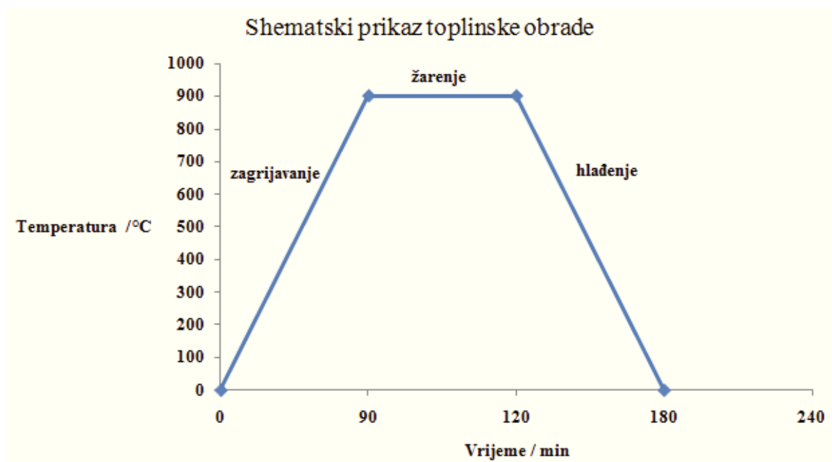
Slika 33. Shematski prikaz provedenog postupka toplinske obrade Cu-Al-Mn-Zn legure
