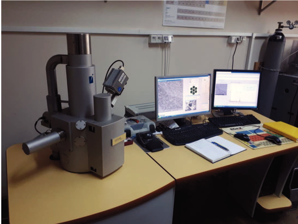
Slika 38. Fotografija pretražnog elektronskog mikroskopa Tescan VEGA 5136 MM
