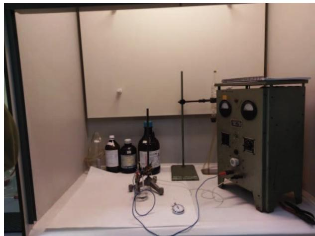
Slika 34. Elektrolitičko nagrizanje uzorka (aparatura)
