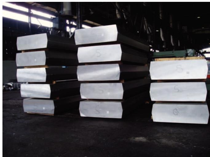
Slika 20. Lijevani aluminijski blokovi
