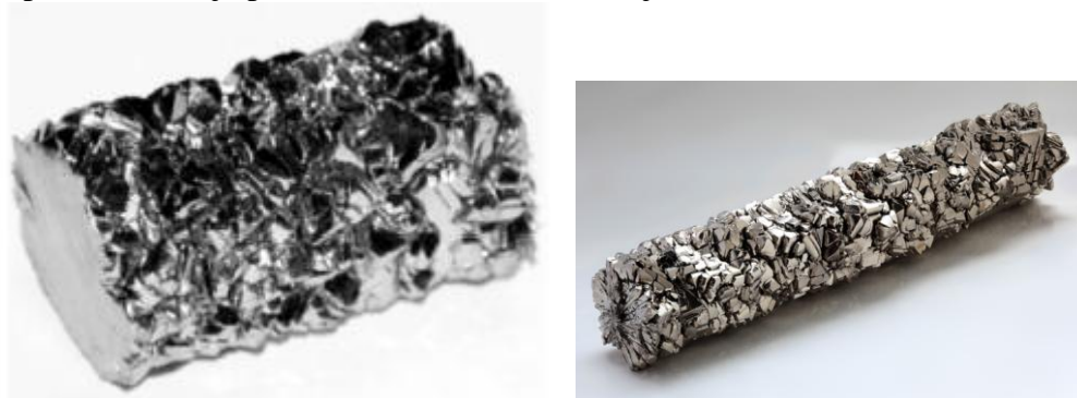
Slika 1. Kristal titana dobiven van Arkel-de Boer (tzv. jodidnim) postupkom [7,8]
