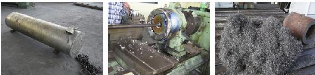
a) Ti-ingot b) rezanje i oblikovanje ingota c) nerekiclabilna strugotina
