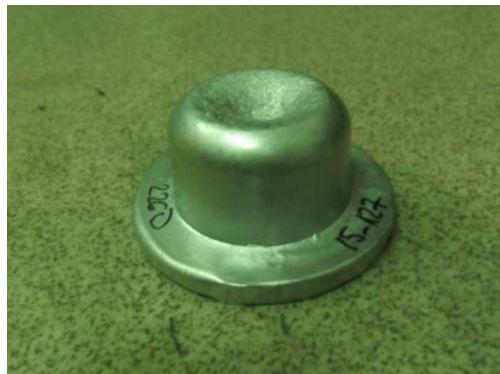
Slika 23. Lijevani uzorak za ispitivanje kemijske analize uzorka taline iz peći.
