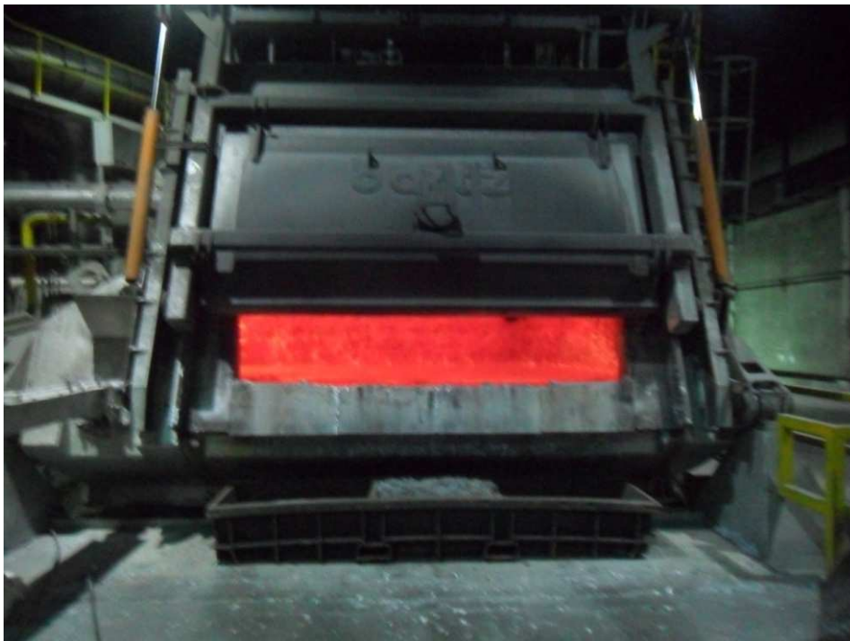
Slika 21. Peć za taljenje legura aluminija u ljevaonici CIAL d.o.o.
