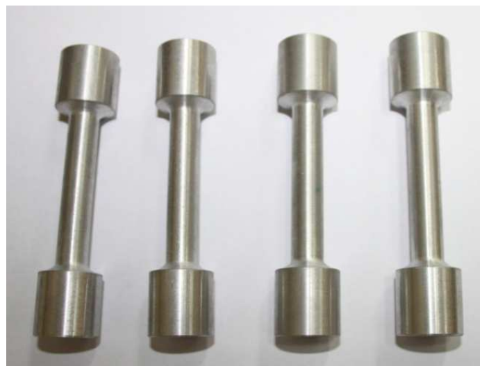
Slika 32. Ispitni uzorci za vlačna ispitivanja.
