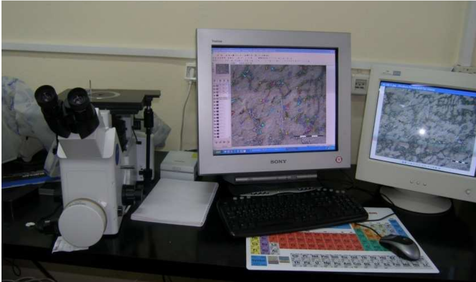
Slika 27. Svjetlosni mikroskop Olympus DP70.
