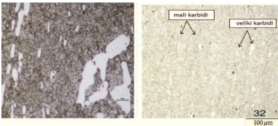
Slika 5. Nejednolika raspodjela karbida u alatnom čeliku [25]
