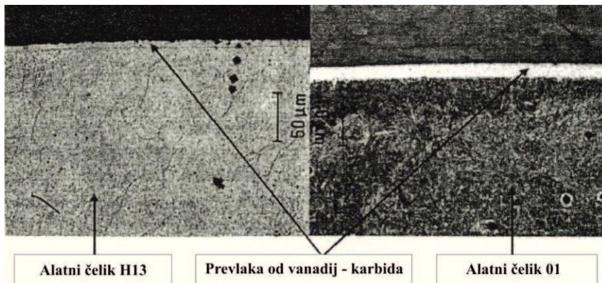
Slika 3. Prikaz nanešenog sloja vanadij karbida na alatnim čelicima za rad u hladnom (AISI 01) i toplo stanju (AISI H13) [13]
