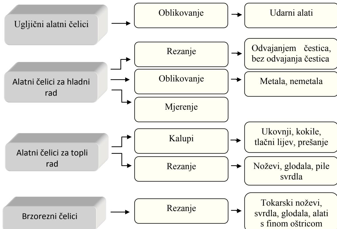
Slika 1. Podjela alatnih čelika prema namjeni
