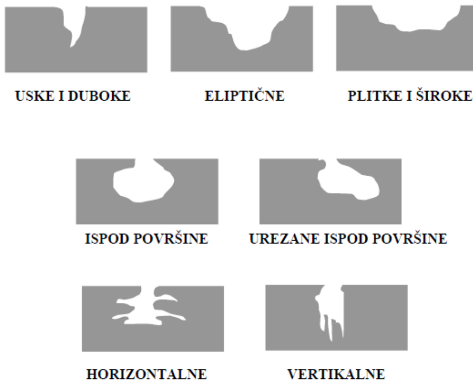
Slika 6. Oblici korozijskih oštećenja jamičaste korozije [15]
