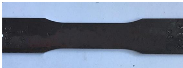
Slika 16. Uzorak pravokutnog poprečnog presjeka obrađen CNC strojem
