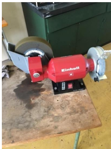
Slika 20. Brusilica Einhell TC-WD 150/200
