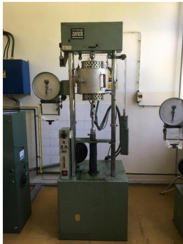
Slika 17. Kidalica Zwick 50 kN
