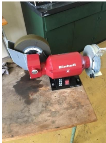
Slika 20. Brusilica Einhell TC-WD 150/200
