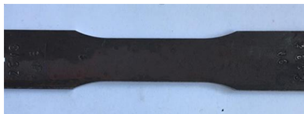
Slika 16. Uzorak pravokutnog poprečnog presjeka obrađen CNC strojem
