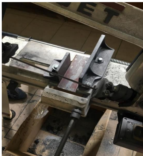
Slika 15. Rezanje uzorka na odgovarajuće dimenzije
