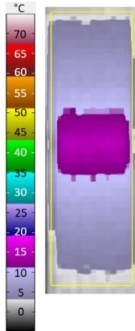
Slika 24. Maksimalna promjena temperature na ispitnom dijelu uzorka
