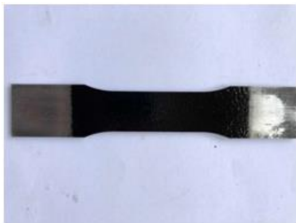
Slika 17. Uzorak nakon nanošenja premaza
