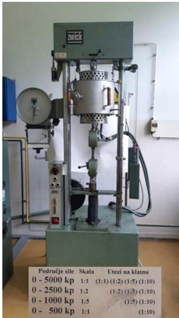
Slika 10. Kidalica Zwick 50 kN i mjerna područja.
