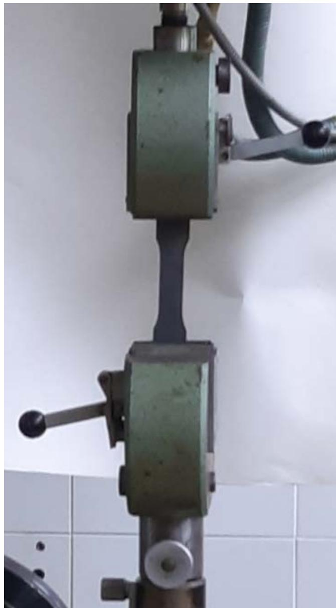
Slika 11. Čeljusti kidalice s postavljenim ispitnim uzorkom
