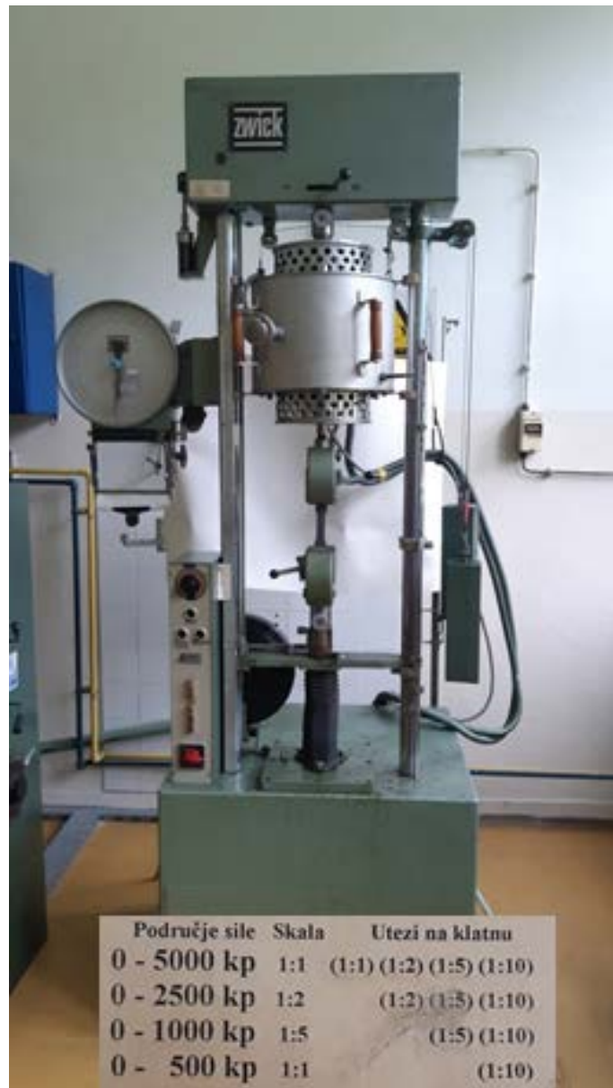
Slika 10. Kidalica Zwick 50 kN i mjerna područja.
