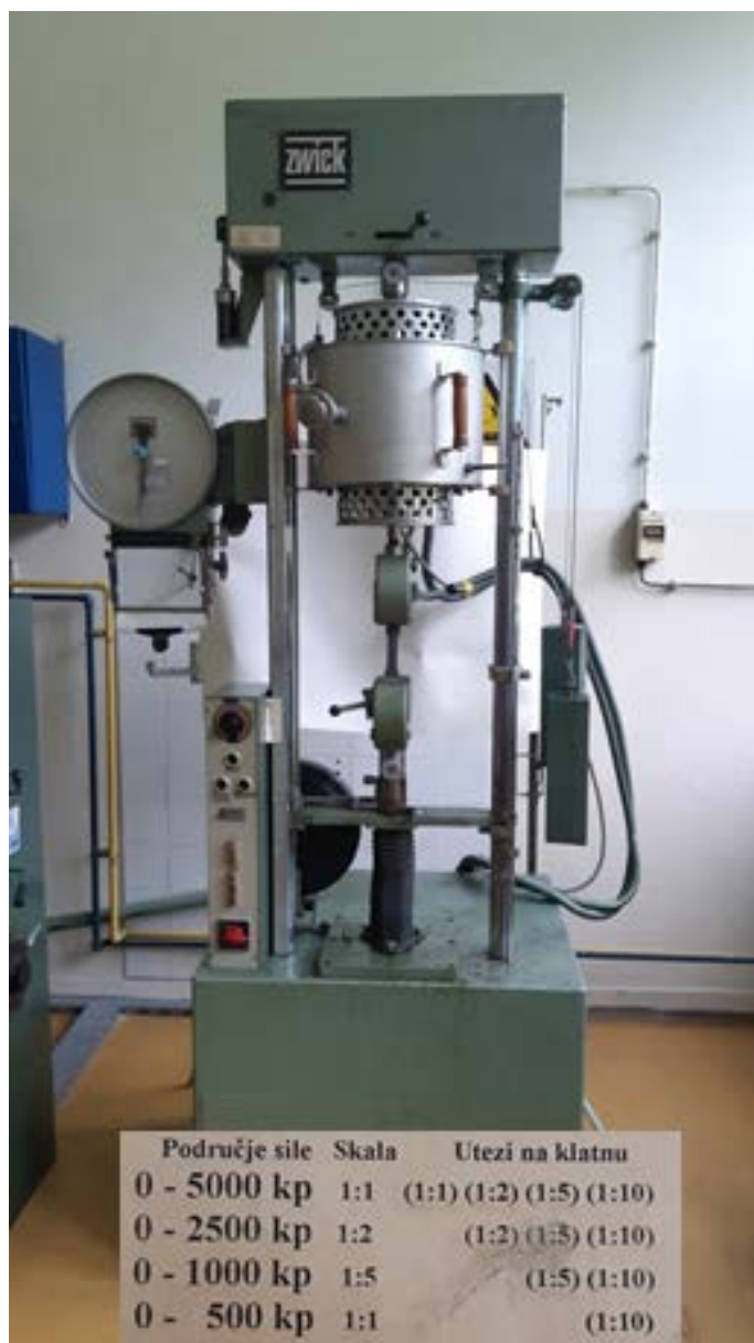
Slika 10. Kidalica Zwick 50 kN i mjerna područja.
