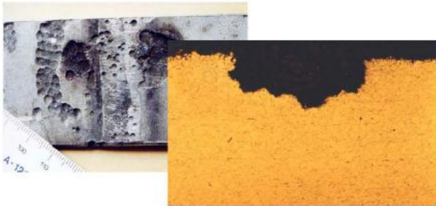
Slika 11. Razaranja materijala pjegastom korozijom [13]
