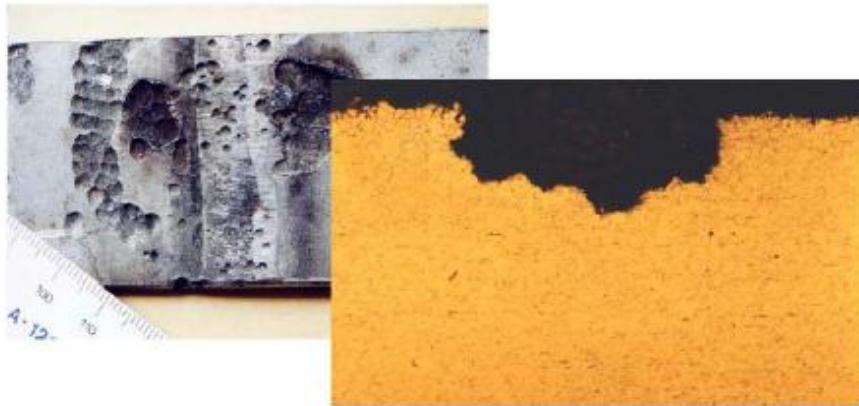
Slika 11. Razaranja materijala pjegastom korozijom [13]
