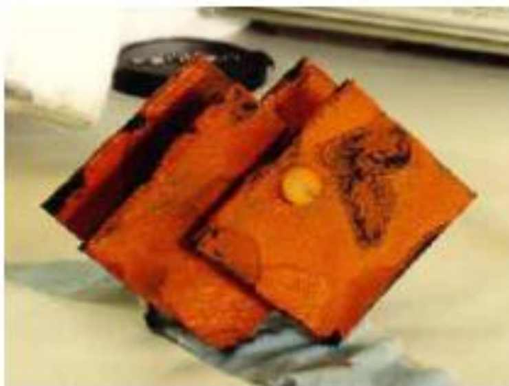
Slika 10. Opća korozija metala [13]
