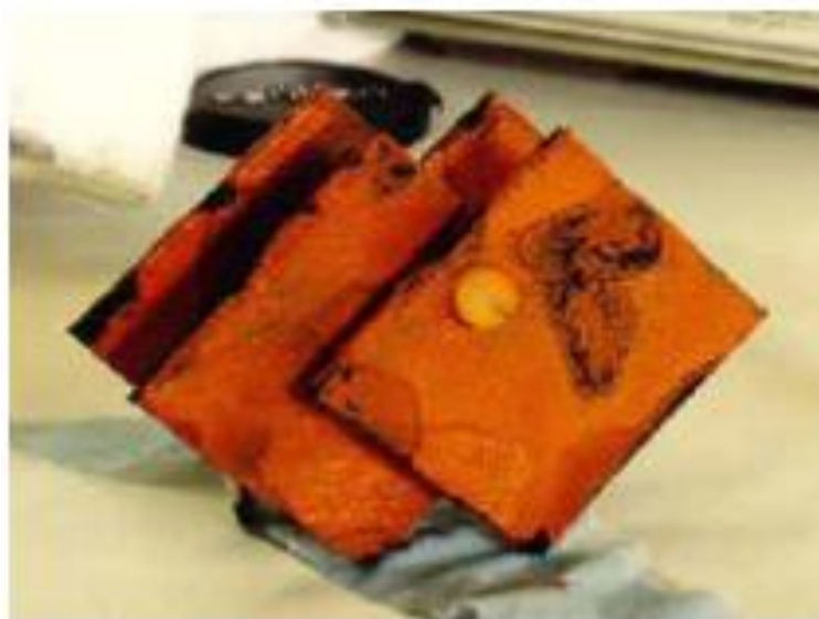
Slika 10. Opća korozija metala [13]
