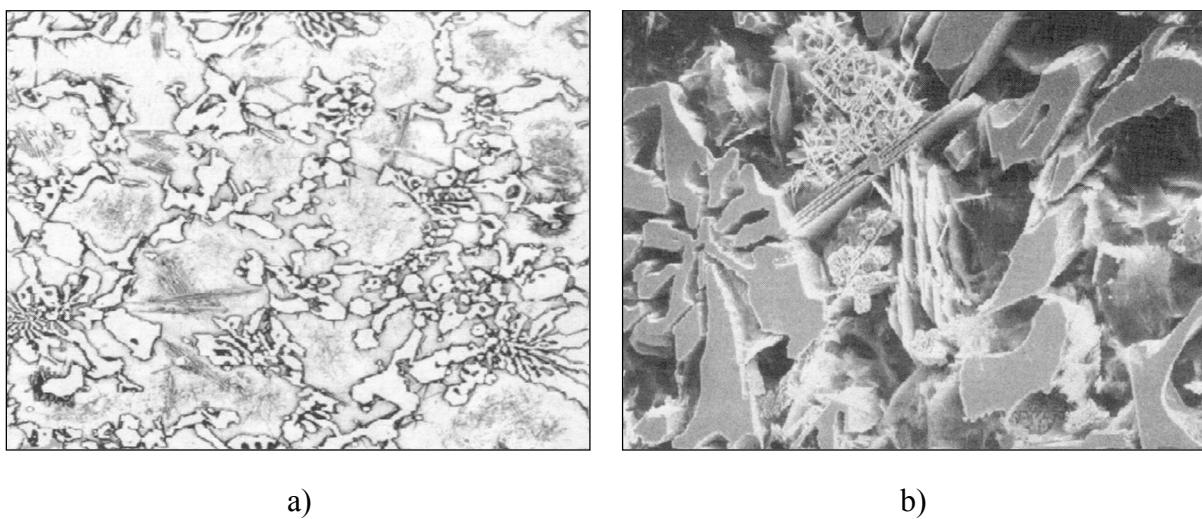
Slika 8. a) metalografska snimka mikrostrukture Ni-Hard 4 u lijevanom stanju, povećanje 500x, b) snimka  $\text{M}_7\text{C}_3$  karbida napravljena pretražnim elektronskim mikroskopom (SEM), povećanje 1200x [2]
