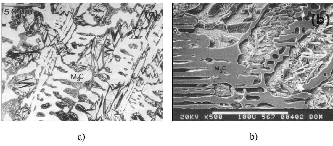
Slika 4. a) metalografska snimka mikrostrukture Ni-Hard 1 u lijevanom stanju, b) snimka  $M_3C$  karbida napravljena pretražnim elektronskim mikroskopom (SEM) [2]
