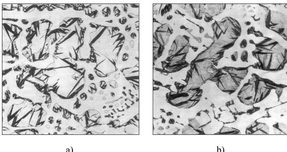
Slika 14. Mikrostruktura Ni-Hard 1 željeznog lijeva prije (a) i nakon (b) dubokog hlađenja [2]
