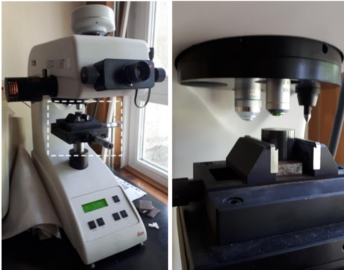
Slika 37. Fotografije mikrotvrdomjera Leica VMHT
