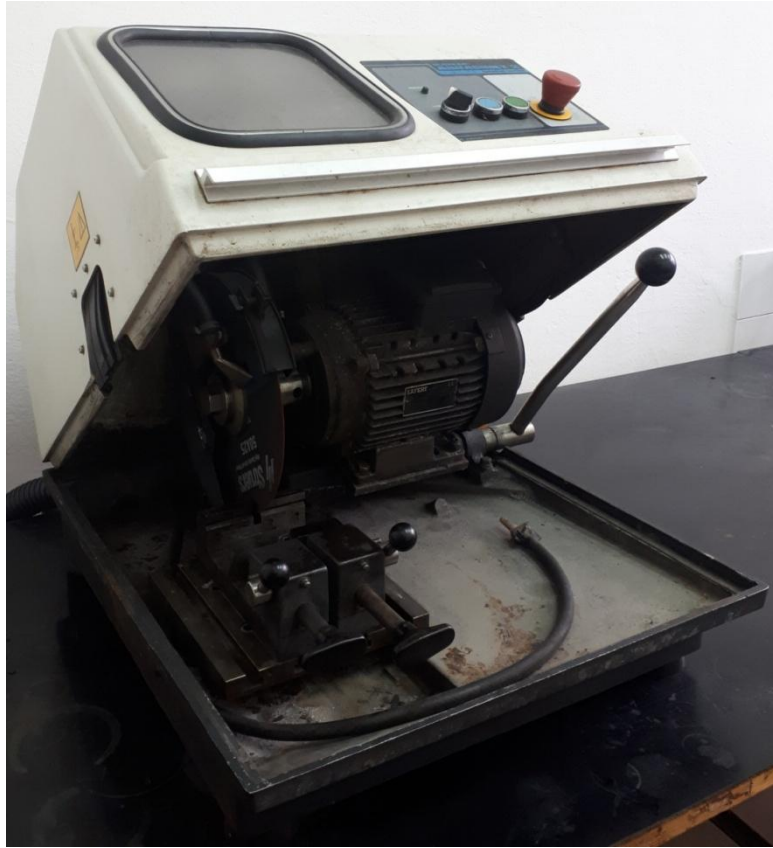
Slika 31. Fotografija uređaja za rezanje uzoraka „Buehler Isomet“
