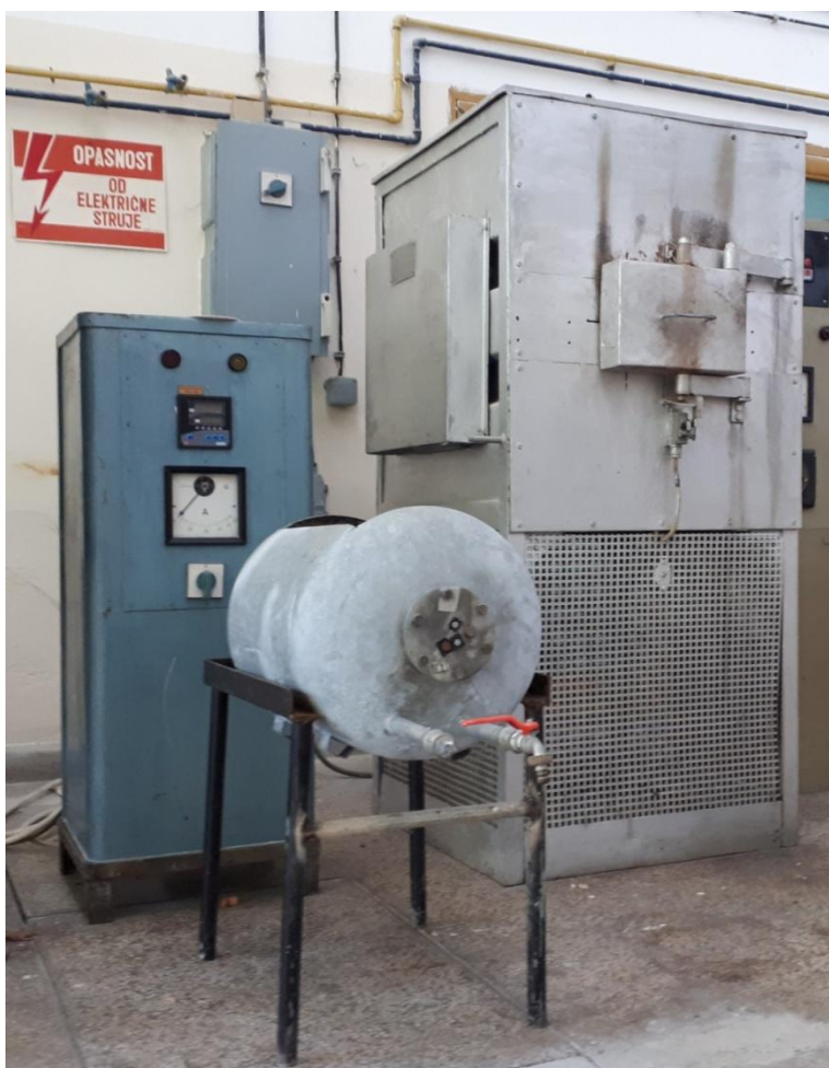
Slika 30. Fotografija elektrootporne komorne peći za žarenje
