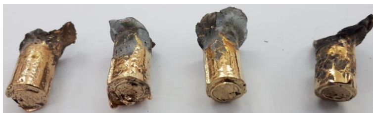
Slika 29. Fotografija ingota proizvedenih lijevanjem u kalup
