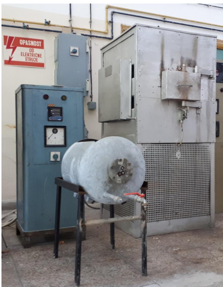
Slika 30. Fotografija elektrootporne komorne peći za žarenje
