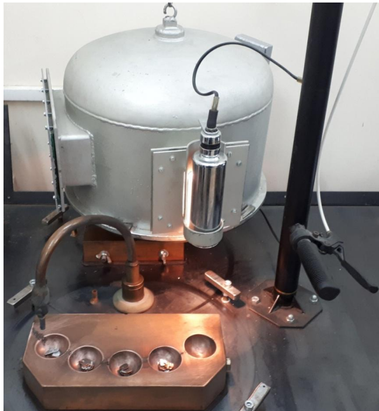
Slika 28. Fotografija elektrolučne peći za taljenje
