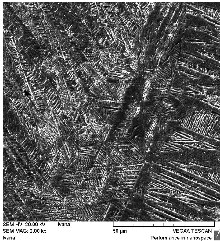
Slika 56. SEM mikrografije Cu-13Al-2,5Mn-3,5Ni legure u kaljenom stanju pri povećanjima 1000x (a) i 2000x (b)
