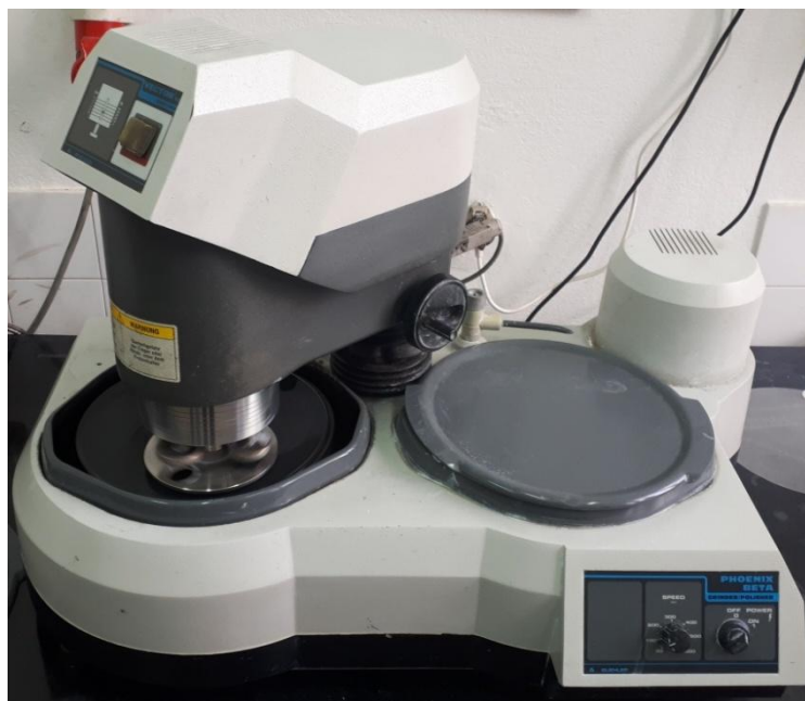
Slika 33. Fotografija uređaja Phoenix Beta proizvođača Buehler za metalografsku pripremu uzoraka
