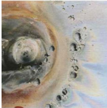
Slika 9. Posljedica rupičaste korozije [11]
