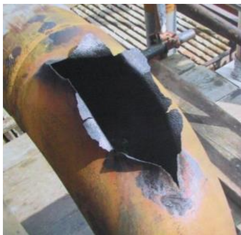
Slika 7. Posljedica erozijsko korozivnog oštećenja cjevovoda za transport nafte [14]
