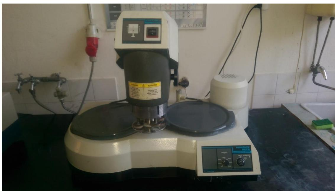
Slika 25. Uređaj za brušenje i poliranje Buehler
