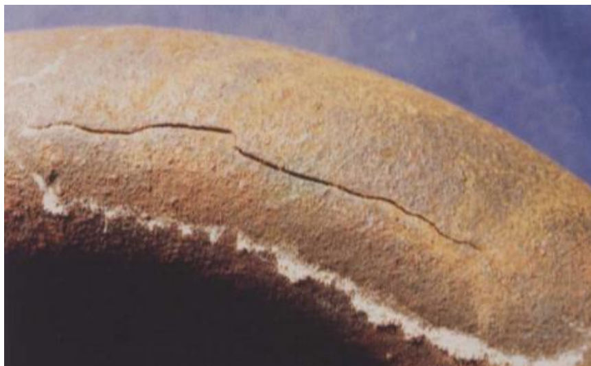
Slika 6. Primjer napetosne korozije ugljičnog čelika – interkristalni karakter loma [13]
