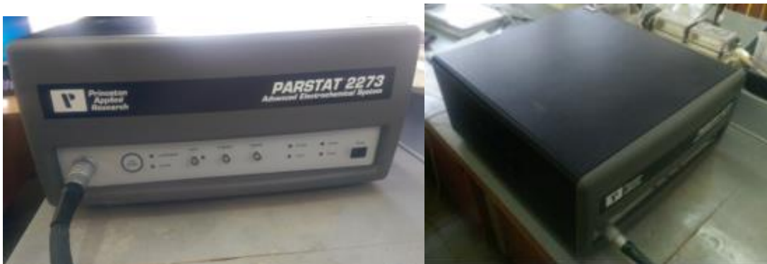
Slika 22. Mjerni uređaj za voltametrijska ispitivanja, potenciostat/galvanostat „Parstat 2273“
