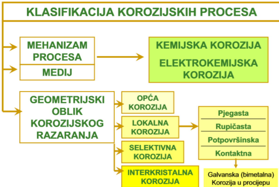
Slika 2. Klasifikacija korozivskih procesa [7]
