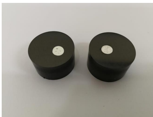
Slika 56 Pripremljeni uzorci iz epruveta iz ASTM kokile za metalografska ispitivanja
