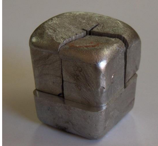
Slika 51. Izrezani odljevak iz Croning lončića
