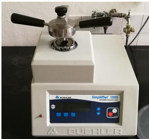
Slika 53. Uređaj tipa Buehler za zalijevanje uzoraka na toplo
