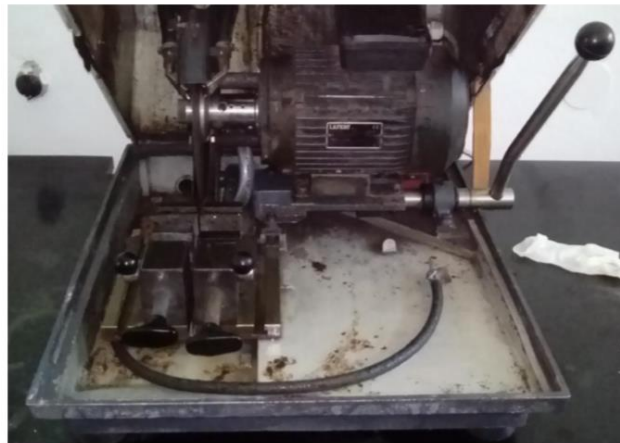
Slika 52. Rezalica Buehler za izradu uzoraka
