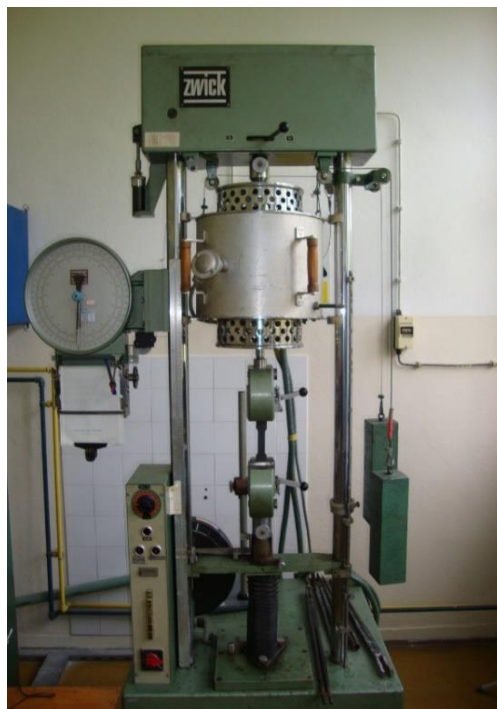
Slika 49. Kidalica Zwick 50 kN
