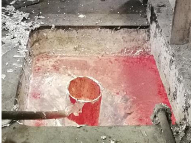
Slika 40. Lonac za talinu spojen s peći
