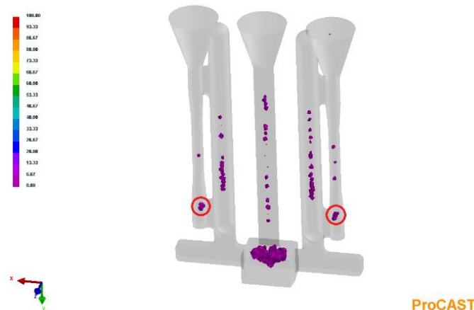
Slika 61. Prikaz poroznosti unutar ProCAST programa
