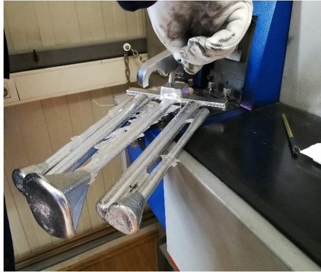
Slika 46. Odljevak iz ASTM kalupa
