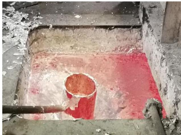
*Slika 40. Lonac za talinu spojen s peći*
