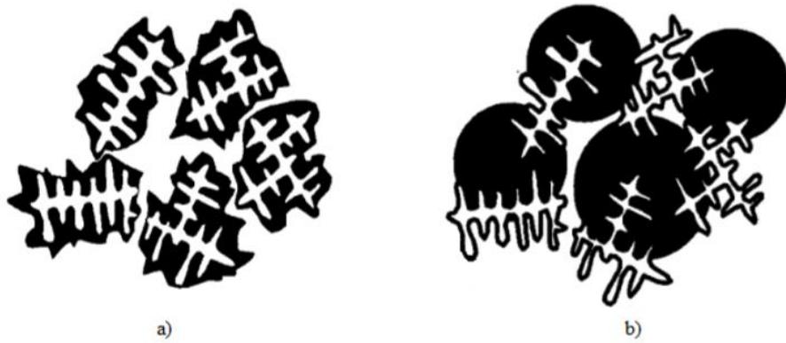
*Slika 31. Shematski prikaz nastajanja eutektika prema postojećim mehanizmima [17]*
