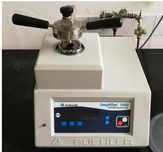
Slika 53. Uredaj tipa Buehler za zalijevanje uzorka na toplo
