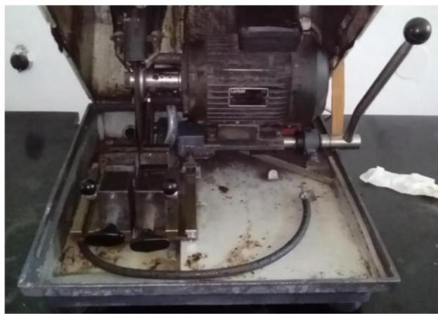
Slika 52. Rezalica Buehler za izradu uzorka
