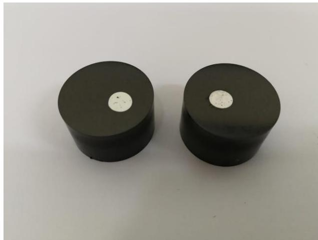
Slika 56 Pripremljeni uzorci iz epruveta iz ASTM kokile za metalografska ispitivanja
