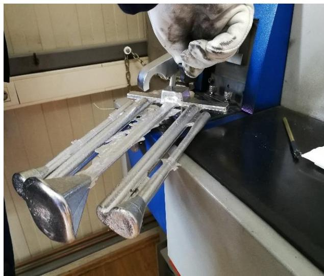
*Slika 46. Odljevak iz ASTM kalupa*
