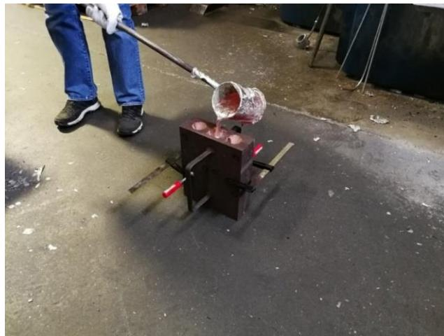
*Slika 44. Lijevanje taline u ASTM kokilu*
