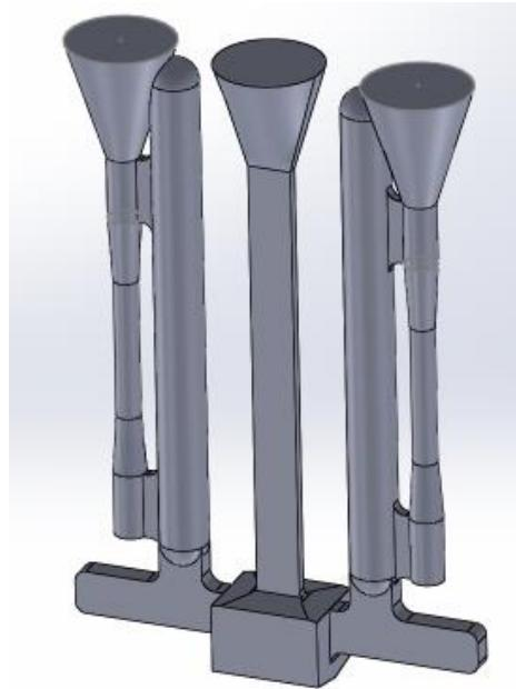
*Slika 41. 3D model odljevka lijevanog u ASTM kokilu*
