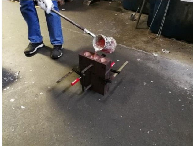
Slika 44. Lijevanje taline u ASTM kokilu
