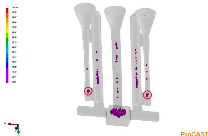
Slika 61. Prikaz poroznosti unutar ProCAST programa
