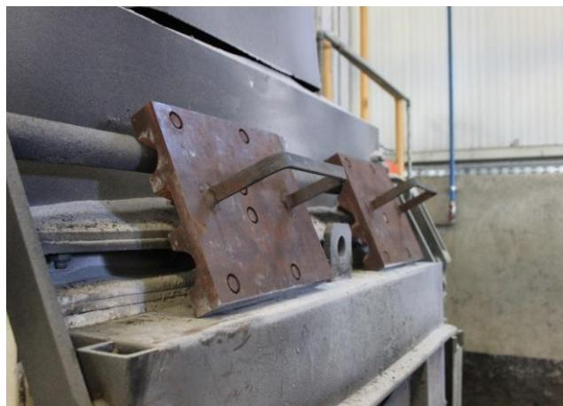
*Slika 42. Predgrijavanje ASTM kokile na vratima peći*
