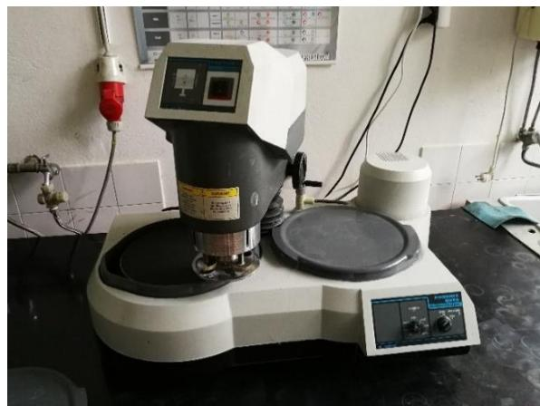
Slika 54. Uredaj za brušenje i poliranje Vektor LC proizvođača Buehler
