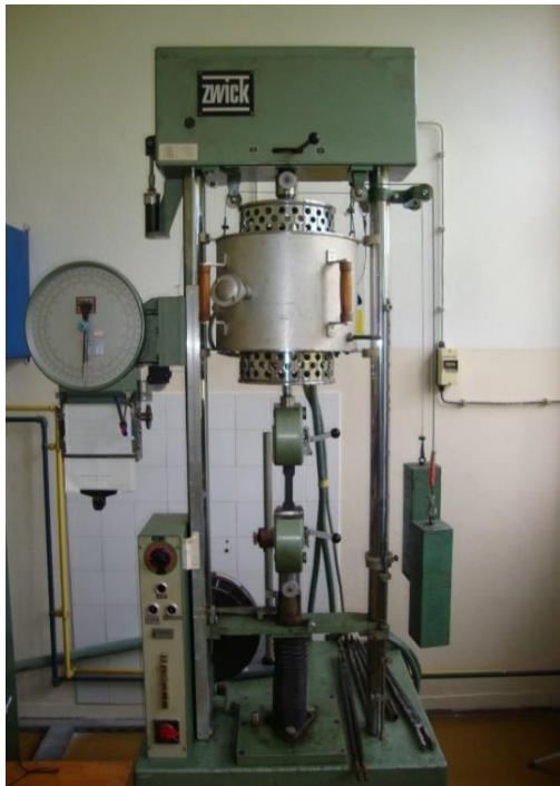
Slika 49. Kidalica Zwick 50 kN
