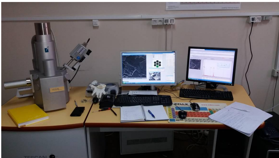
Slika 23. Fotografija pretražnog elektronskog mikroskopa TESCAN VEGA 5136 MM opremljenog s energetske disperzivnim spektrometrom (EDS)
