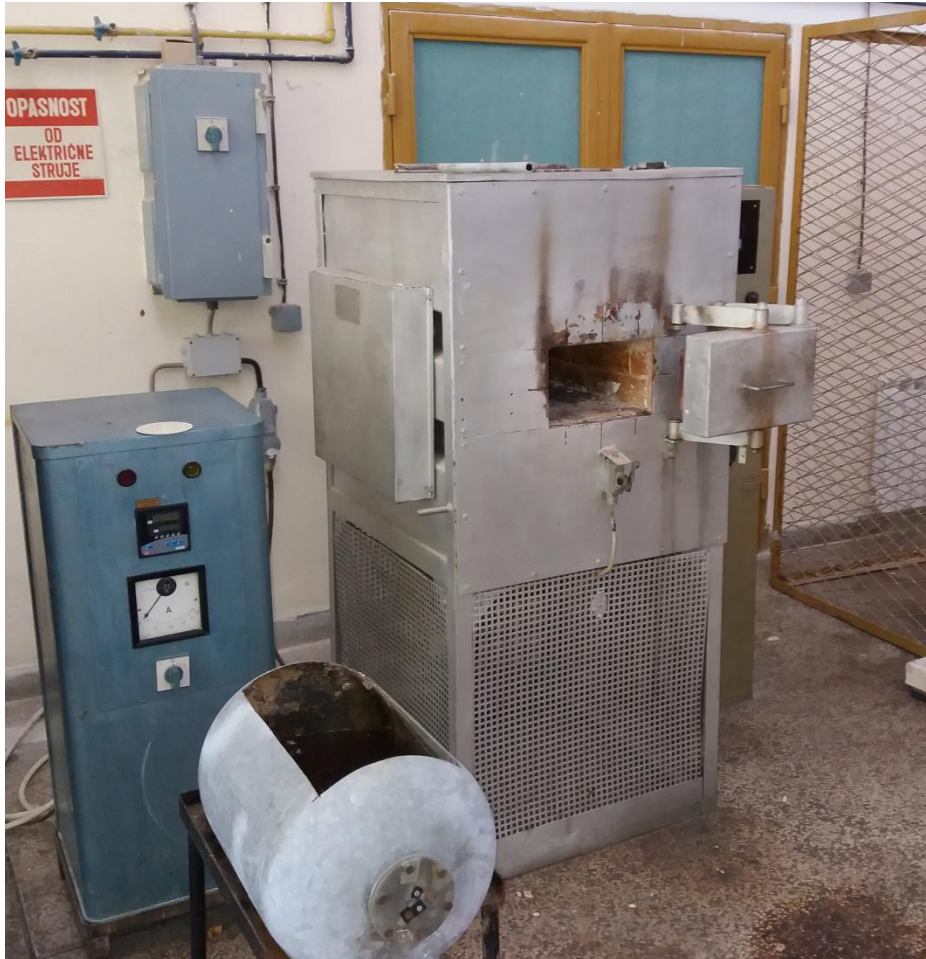
Slika 20. Fotografija peći za žarenje i posude za hlađenje uzoraka
