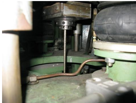
Slika 28. Fotografija izvlačenja šipke legure pri kontinuiranom lijevanju
