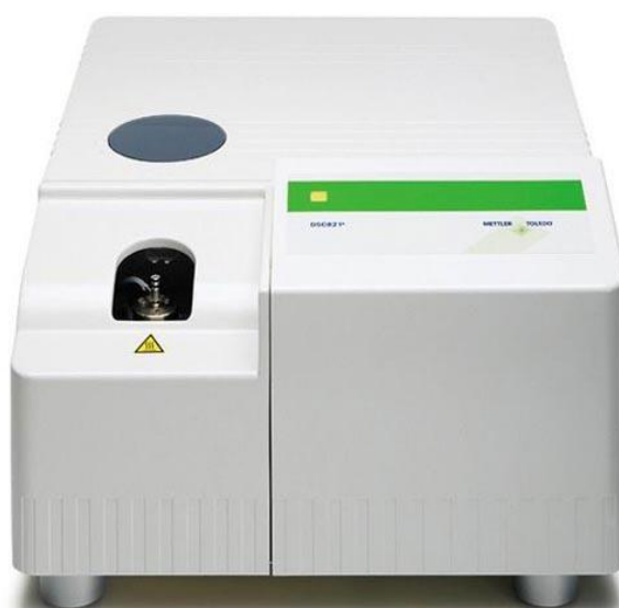
Slika 34. Diferencijalni pretražni kalorimetar, MDSC Mettler-Toledo
