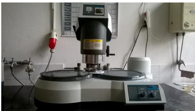
Slika 31. Uređaj za brušenje i poliranje Buehler „Phoenix Beta“
