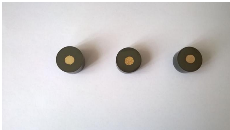
Slika 32. Uzorci Cu-Al-Mn legure uliveni u masu te nagriženi
