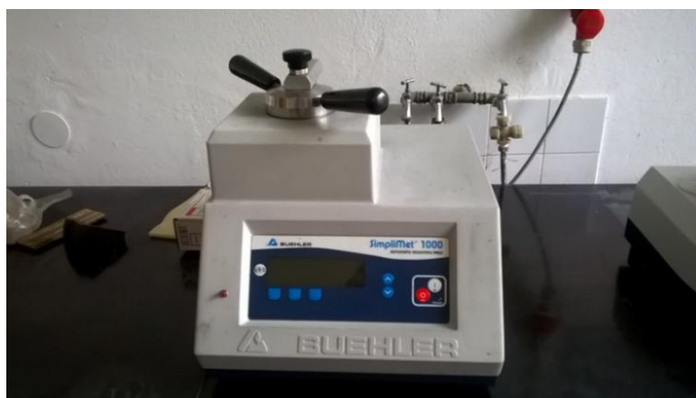
Slika 30. Uređaj za toplo ulijevanje Buehler Simplimet 1000
