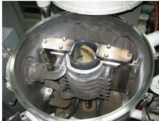
Slika 27. Vakuumska indukcijska peć sa zaštitnom atmosferom argona
