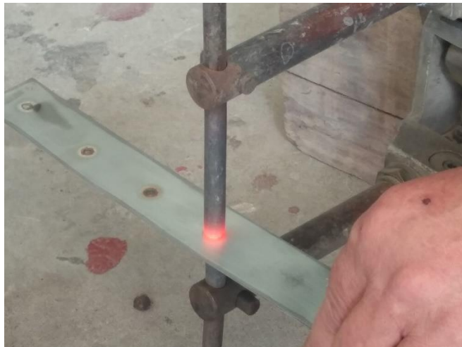
Slika 15. Elektrootporno točkasto zavarivanje izrezanih limova punkt aparat/klještima
