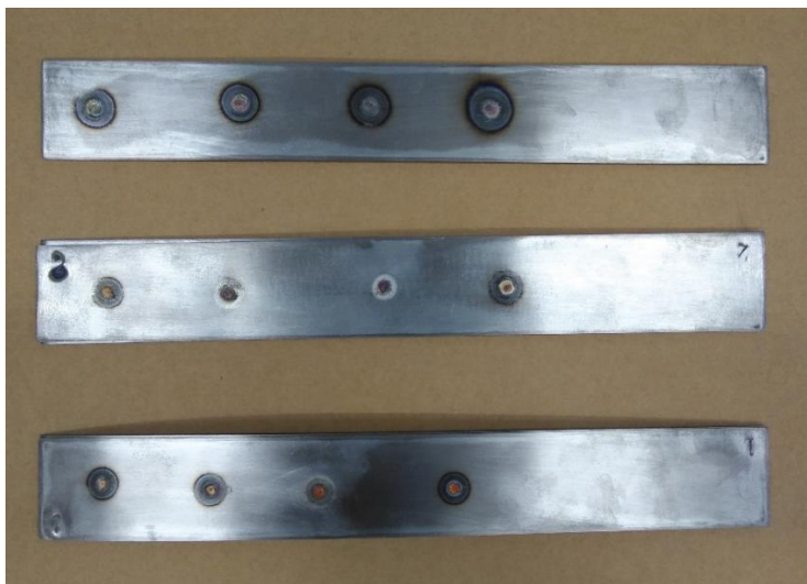
Slika 16. Točkasto zavareni izrezani limovi
