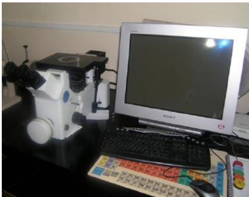
Slika 21. Invertni metalografski mikroskop Olympus GX 51 s digitalnom kamerom DP 70
