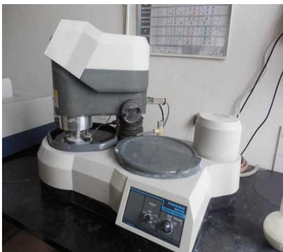
Slika 19. Uređaj za brušenje i poliranje uzoraka zalivenih u masu tijekom rada
