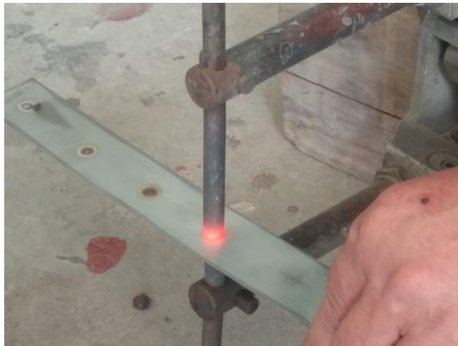
Slika 15. Elektrootporno točkasto zavarivanje izrezanih limova punkt aparat/klještima
