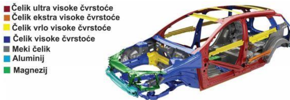
Slika 1. Primjer materijala u izradi samonosive rešetkaste karoserije (Volvo, V60) [1]
