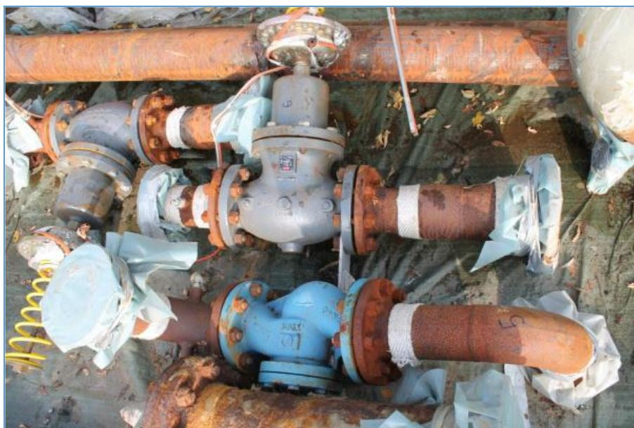
Slika 4. Dijelovi cjevovoda geotermalne vode s naslagama prirodnih radionuklida pronađeni u čeličnom otpadu [29]
