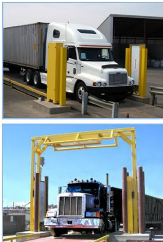
Slika 8. Stacionarni sustavi za nadzor radioaktivnih tvari u čeličnom otpadu (broj instaliranih detektora može biti od 2 do 6) [37,38]
