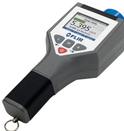
Slika 7. Prijenosni uređaj za utvrđivanje radioaktivnih tvari u čeličnom otpadu identiFINDER R400, FLIR Systems, SAD [32]
