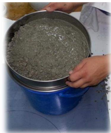
Slika 6. Ispitivanje otpornosti na segregaciju
