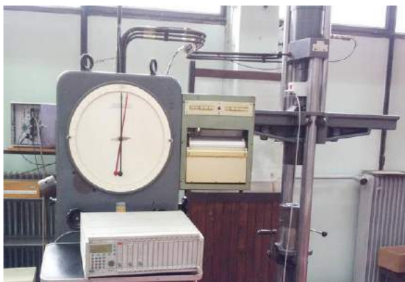
Slika 1. Pozicionirana mjerna ćelija u kidalici
