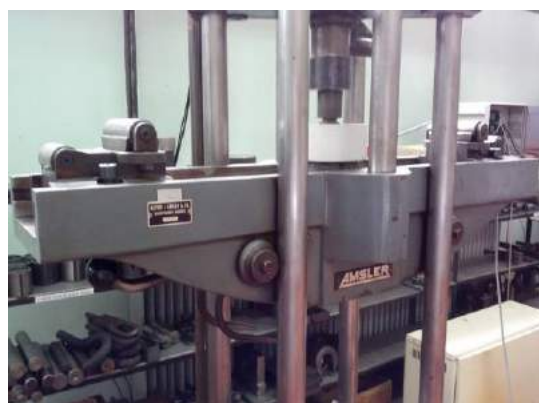
Slika 1. Pozicionirana mjerna ćelija u kidalici
