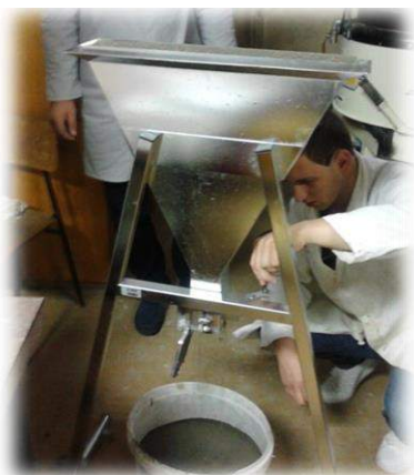
Slika 4. Ispitivanje vremena tečenja kroz V-lijevak
