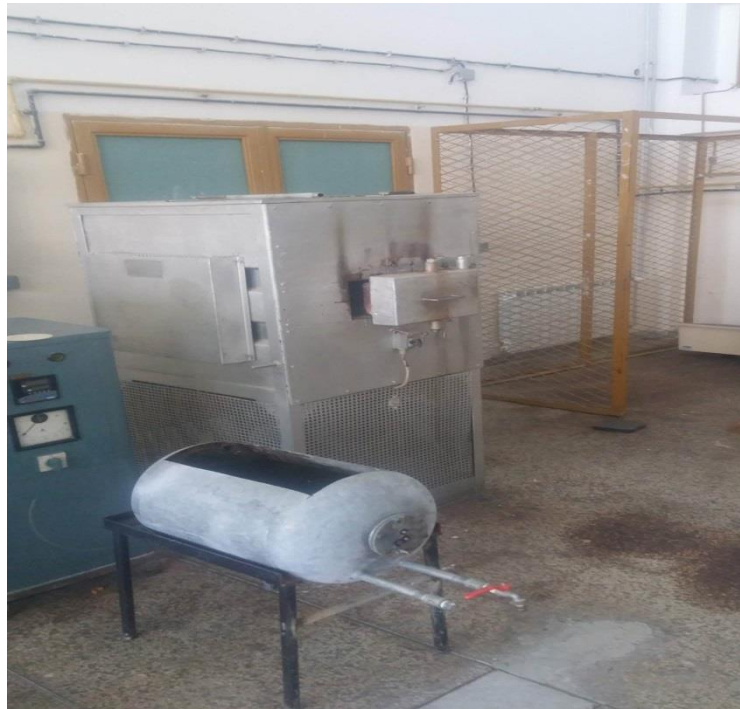
Slika 22. Fotografija elektrootporne komorne peći za žarenje
