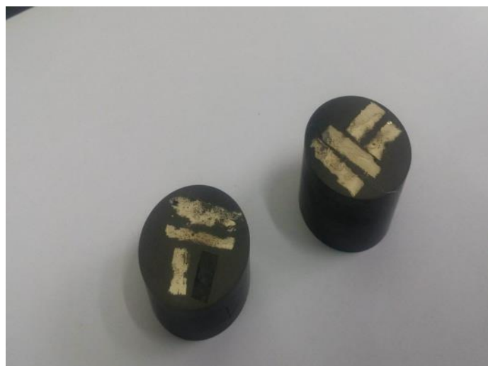
Slika 24. Fotografija uzoraka za mikrostrukturnu analizu Cu-Al-Mn-(Ti) legure nakon metalografske pripreme
