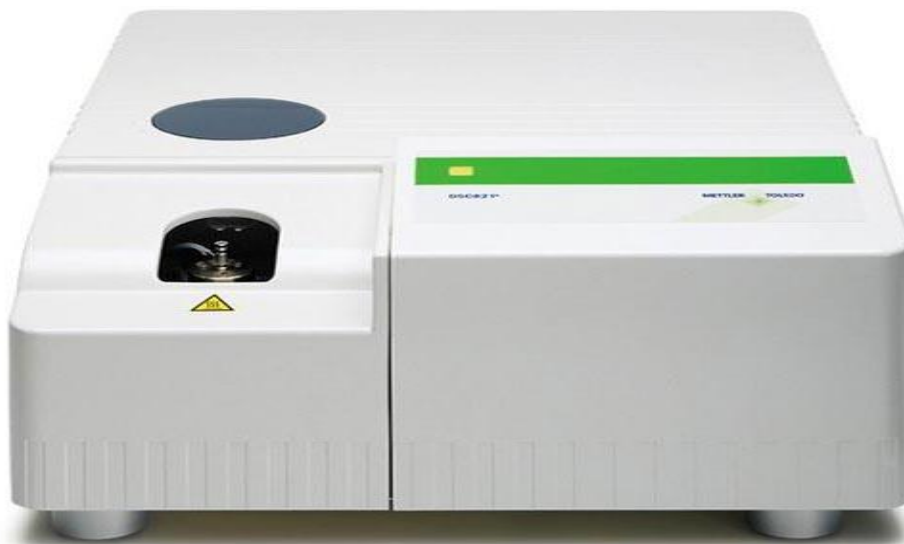
Slika 27. Fotografija diferencijalnog skenirajućeg kalorimetra Mettler Tolledo 822e
