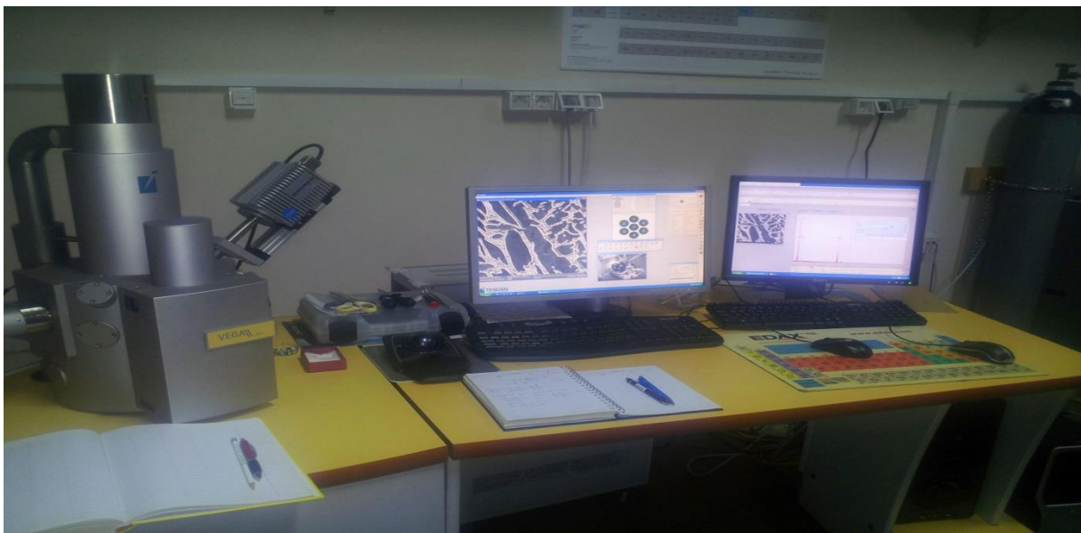
Slika 26. Fotografija pretražnog elektronskog mikroskopa TESCAN VEGA 5136 MM opremljenog uređajem za energetske disperzijske spektroskopije (EDS)
