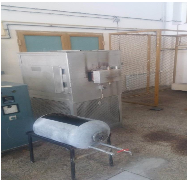
Slika 22. Fotografija elektrootporne komorne peći za žarenje
