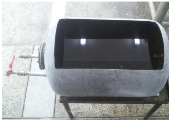
Slika 29. Fotografija posude za hlađenje žarenih uzoraka
