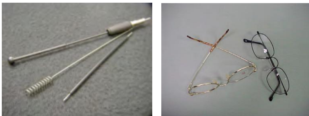
a) antene izrađene od nitinola; b) naočale izrađene od nitinola.
