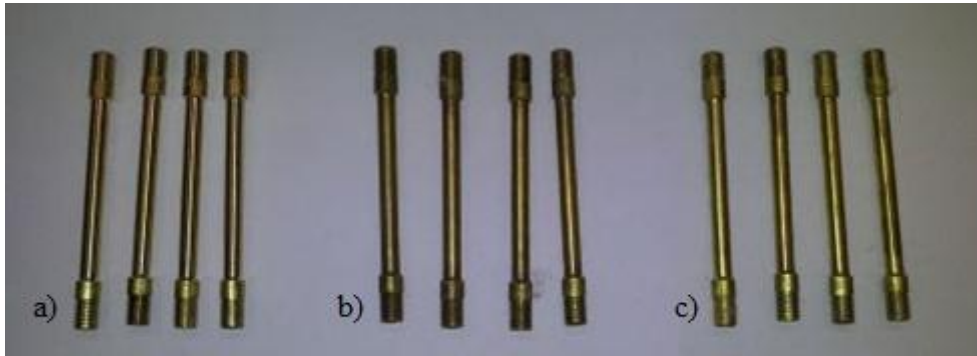
Slika 40. Fotografija uzoraka Cu - Al legure za ispitivanje mehaničkih svojstava;
