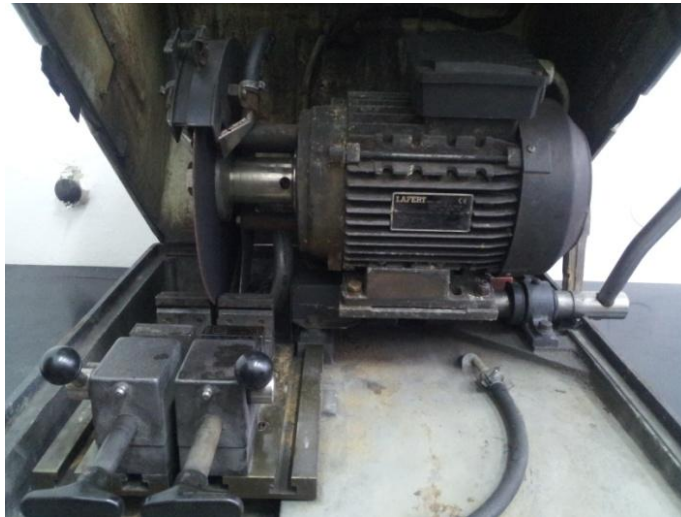
Slika 30. Fotografija rezalice Isomet proizvođača Buehler
