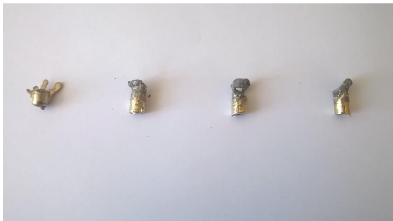
Slika 12. Odliveni cilindrični uzorci Cu-Al-Mn legura
