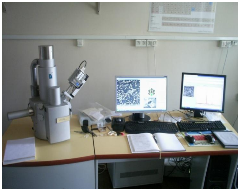
Slika 17. Pretražni elektronski mikroskop Tescan Vega TS 5136 MM
