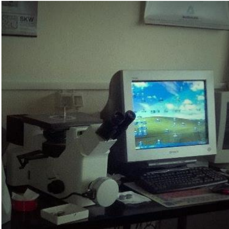
Slika 16. Optički mikroskop s digitalnom kamerom Olympus GX 51
