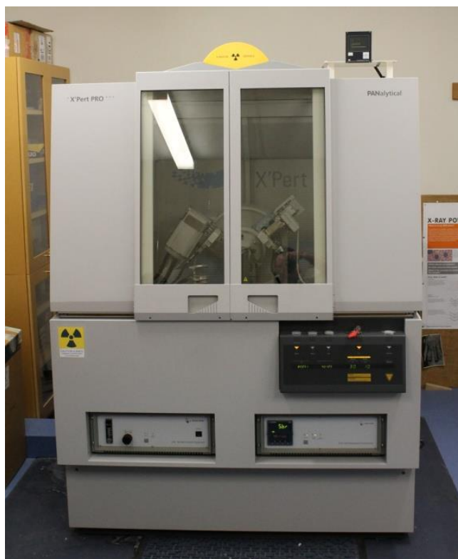
Slika 18. Rendgenski difraktometar PANalytical, X'Pert PRO
