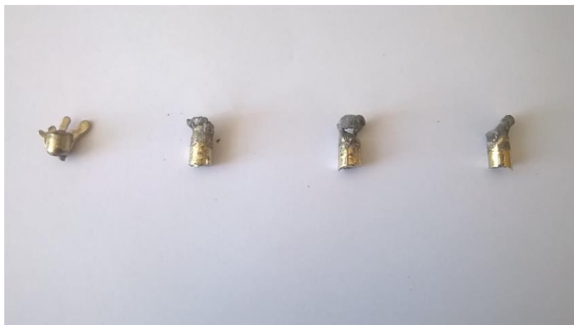
Slika 12. Odliveni cilindrični uzorci Cu-Al-Mn legura
