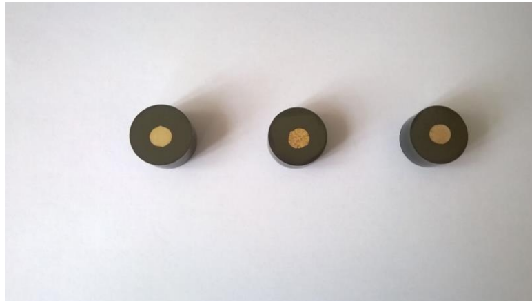
Slika 14. Uzorci zaliveni u plastičnu masu te nagriženi
