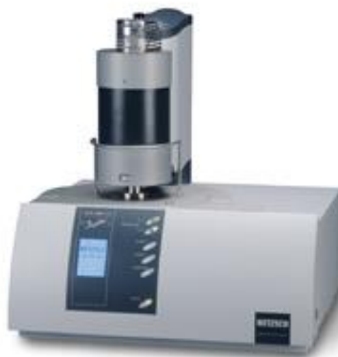
Slika 6. Fotografski snimak simultanog toplinskog analizatora [18]
