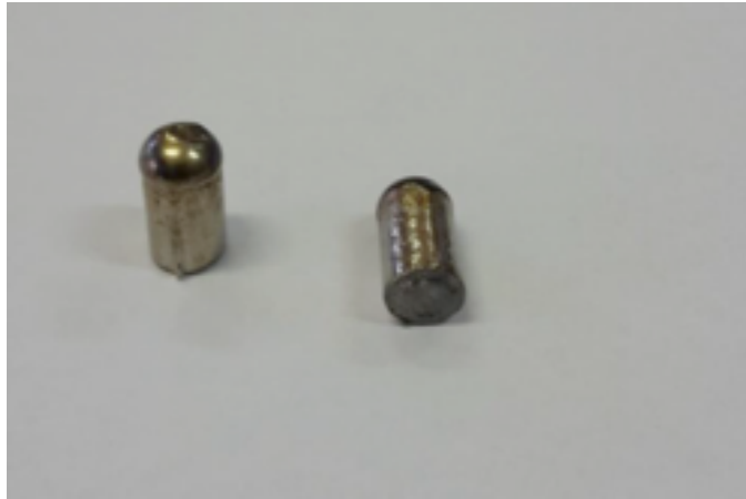
Slika 12. Fotografija ingota dobivenih lijevanjem u kalup.
