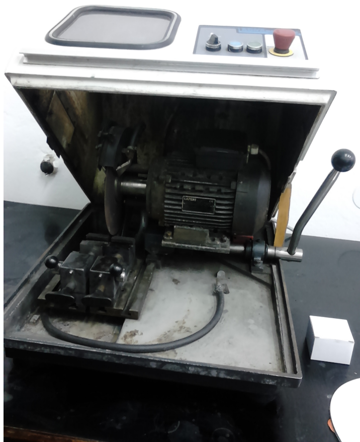
Slika 13. Fotografija uređaja za rezanje uzoraka “Buehler Isomet”.
