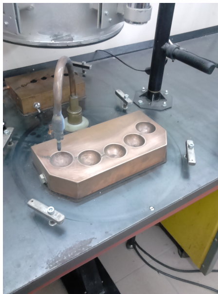
Slika 11. Fotografija peći za taljenje (bakrena anoda).
