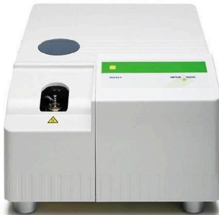
Slika 16. Fotografija uređaja za diferencijalno skenirajuću kalorimetriju “DSC Mettler Toledo DSC882e”.
