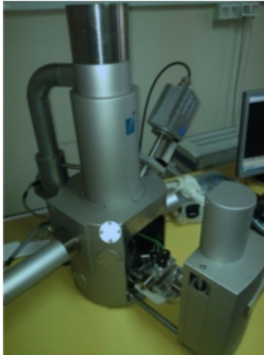
Slika 15. Fotografija pretražnog elektronskog mikroskopa “Tescan Vega TS 5136 MM”.
