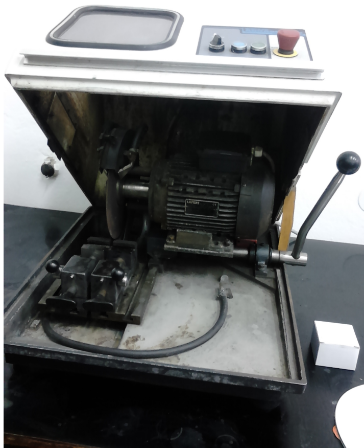
Slika 13. Fotografija uređaja za rezanje uzoraka “Buehler Isomet”.
