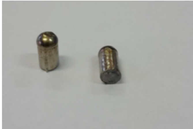
Slika 12. Fotografija ingota dobivenih lijevanjem u kalup.
