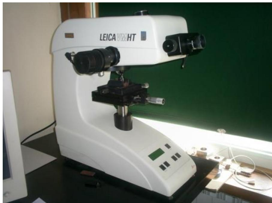
Slika 19. Fotografija tvrdomjera Leica VHMT
