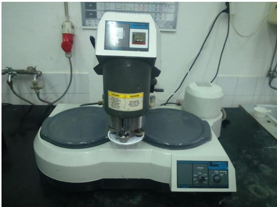
Slika 15. Fotografija uređaja PHOENIX BETA za metalografsku pripremu
