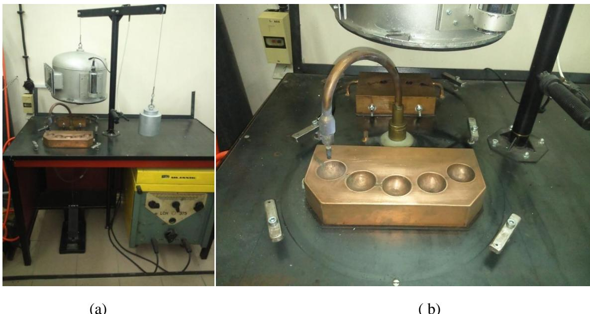
Slika 12. Fotografija elektrolučne vakumske peći (a) i bakrenog bloka za elektrolučno taljenje metala elektrolučne vakumske peći (b)
