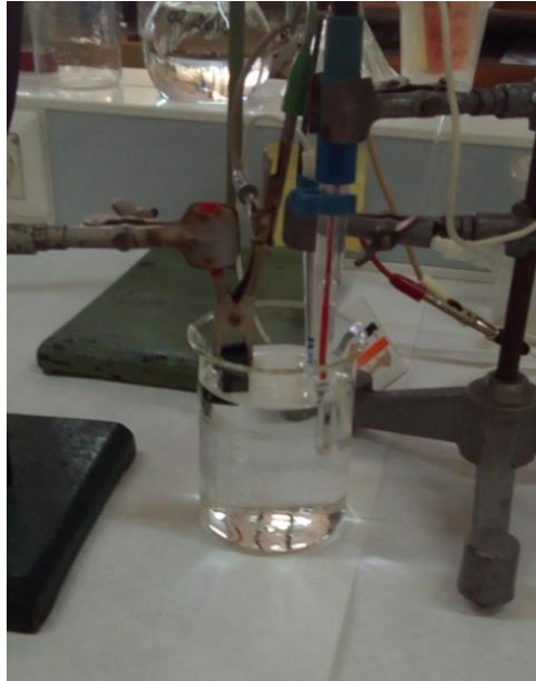
Slika 12. Standardna troelektrodna ćelija za elektrokemijska mjerenja
