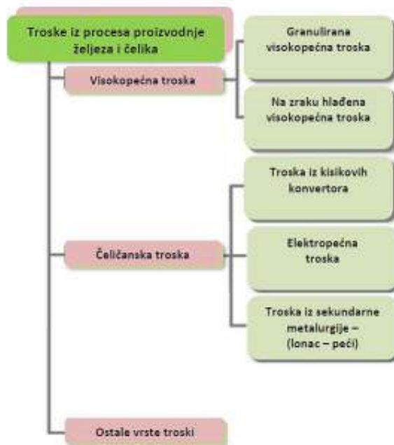
Slika 1. Razvrstavanje željeznih troski po mjestu nastanka [6]
