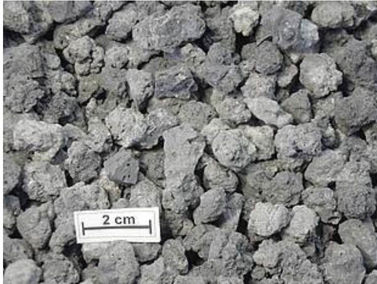
Slika 7. Troska iz kisikovog konvertora [17]
