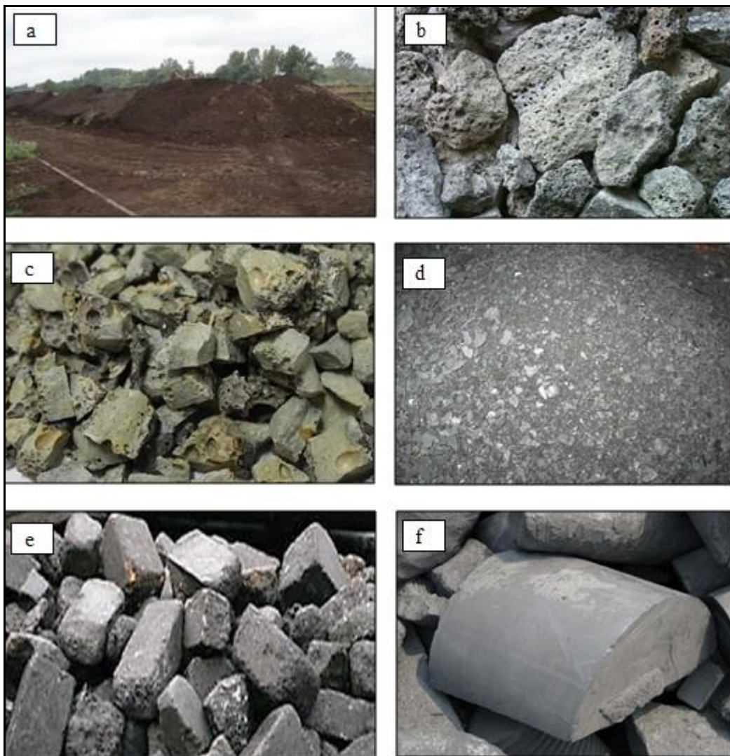
Slika 2. Najčešći proizvodni otpadi iz procesa proizvodnje čelika elektropećnim postupkom [14,16]
