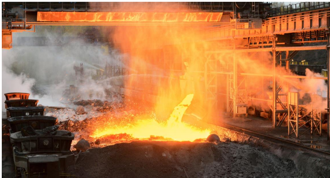
Slika 9. Hlađenje troske potpomognuto vodenim topovima [17]
