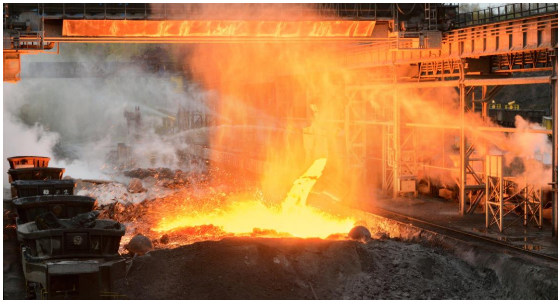
Slika 9. Hlađenje troske potpomognuto vodenim topovima [17]
