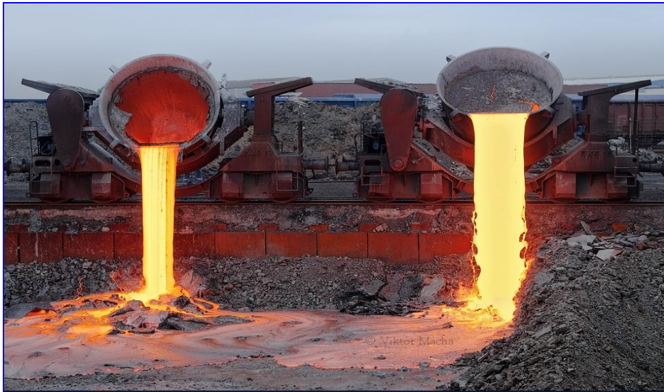
Slika 8. Izlijevanje troske na mjesto za hlađenje [16]
