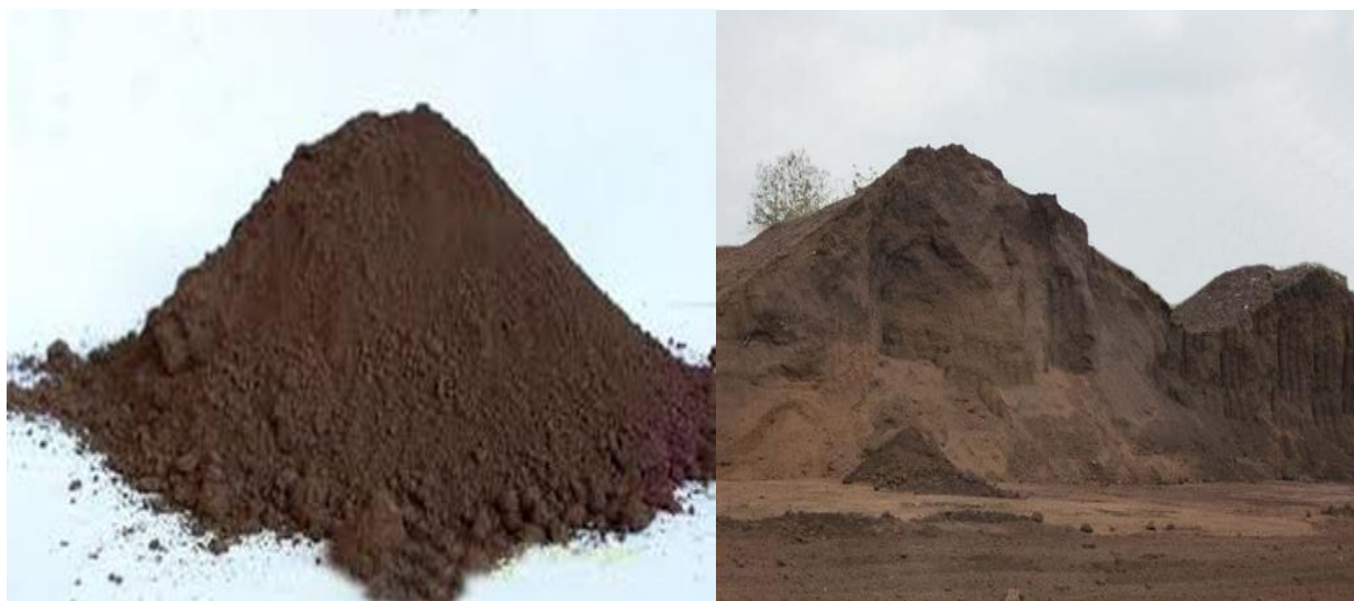
Slika 1: Izgled elektropećne prašine: a) u zdjelici; b) nepropisno odložene na tlu u krugu čeličane [1]
