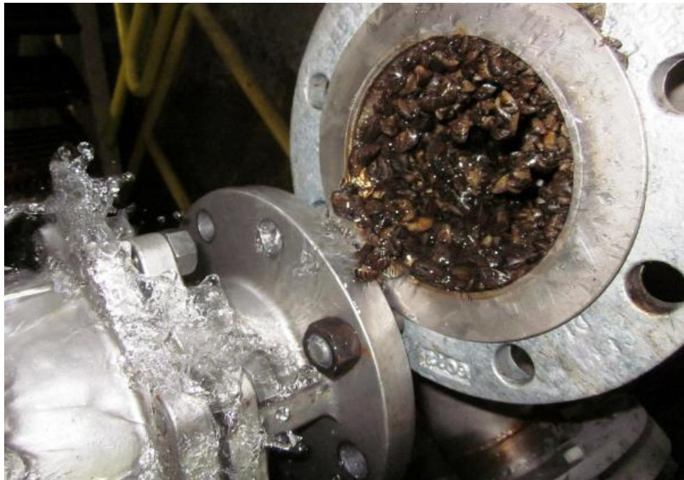
Slika 8. Začepljenje vodovodne cijevi uzrokovano raznolikom trokutnjačom<sup>26</sup>
