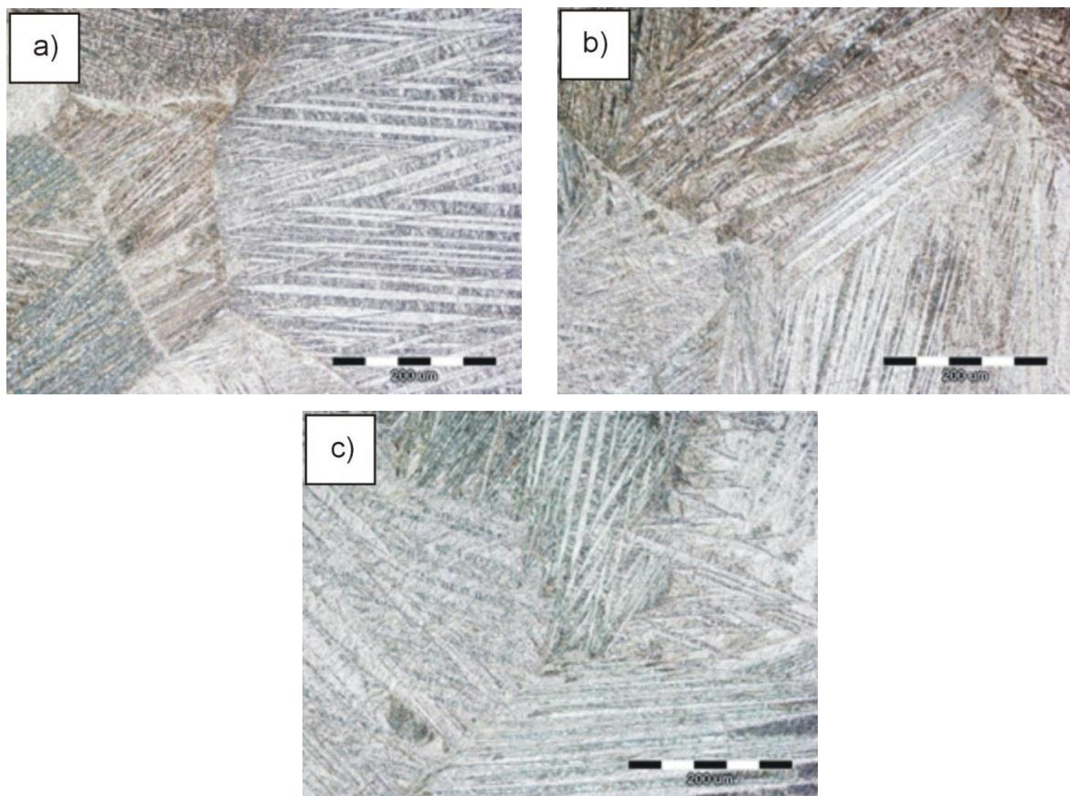
Slika 51. Optičke mikrografije kaljene CuAlNi slitine s prisjetljivošću oblika; 850 °C/60'/H<sub>2</sub>O (a), 885 °C/60'/ H<sub>2</sub>O (b) i 920 °C/60'/ H<sub>2</sub>O (c); povećanje 200x
