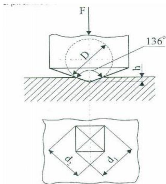
Slika 43. Mjerjenje tvrdoće po Vickersu [96]
