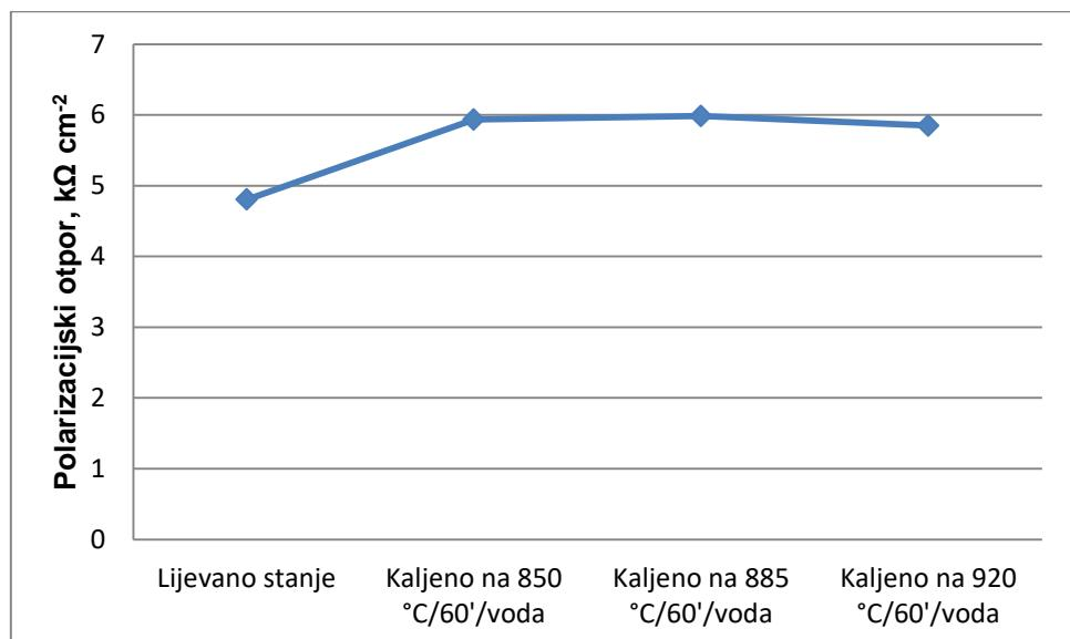
Slika 114. Utjecaj temperature kaljenja na vrijednosti polarizacijskog otpora
