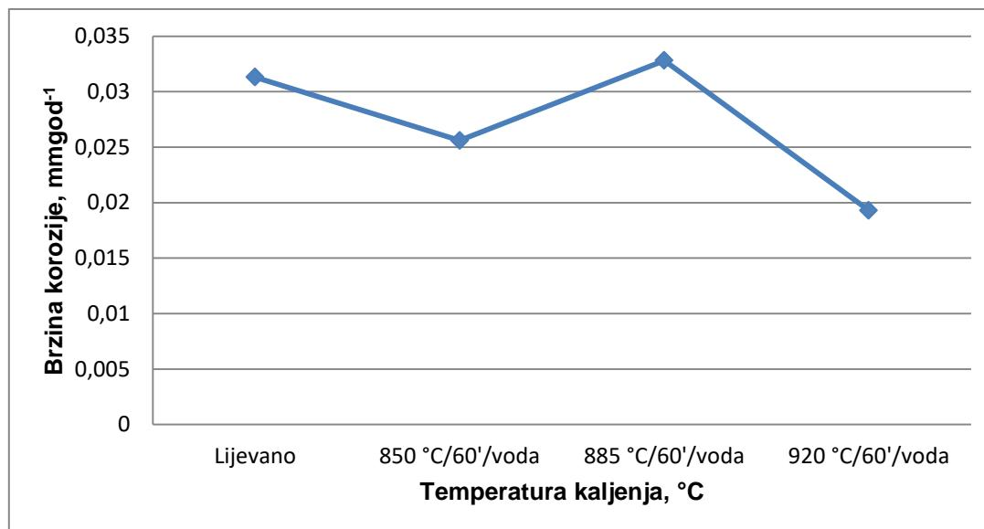
Slika 116. Utjecaj temperature kaljenja na brzinu korozije
