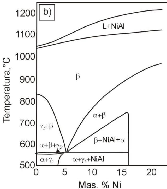
Slika 16. Ternarni fazni dijagrami CuAlNi slitine vertikalni presjek: kod 3 mas.% Ni
