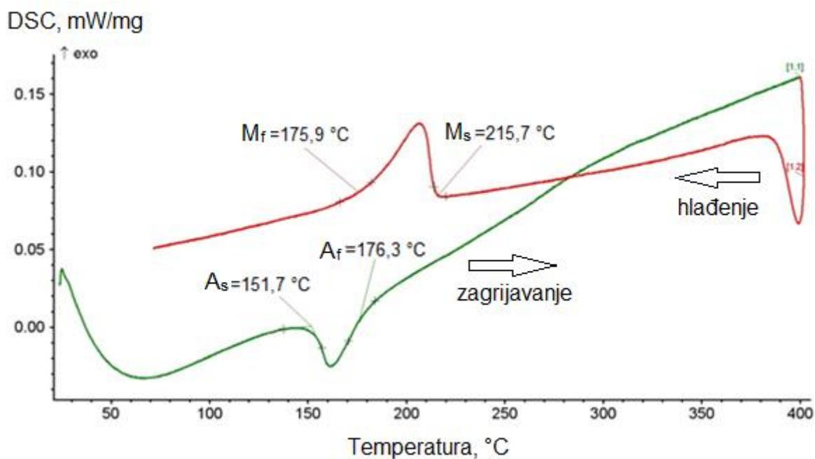
Slika 68. DSC krivulje CuAlNi slitine nakon kaljenja  $885 \text{ } ^\circ\text{C}/60'/\text{H}_2\text{O}$
