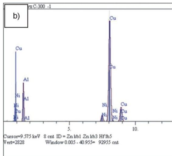
Slika 61. SEM mikrografija CuAlNi slitine s prisjetljivošću oblika nakon kaljenja  $850\text{ }^{\circ}\text{C}/60'\text{/H}_2\text{O}$  (a) i popuštanja  $300\text{ }^{\circ}\text{C}/60'\text{/H}_2\text{O}$  i EDS spektar pozicije 1 (b)
