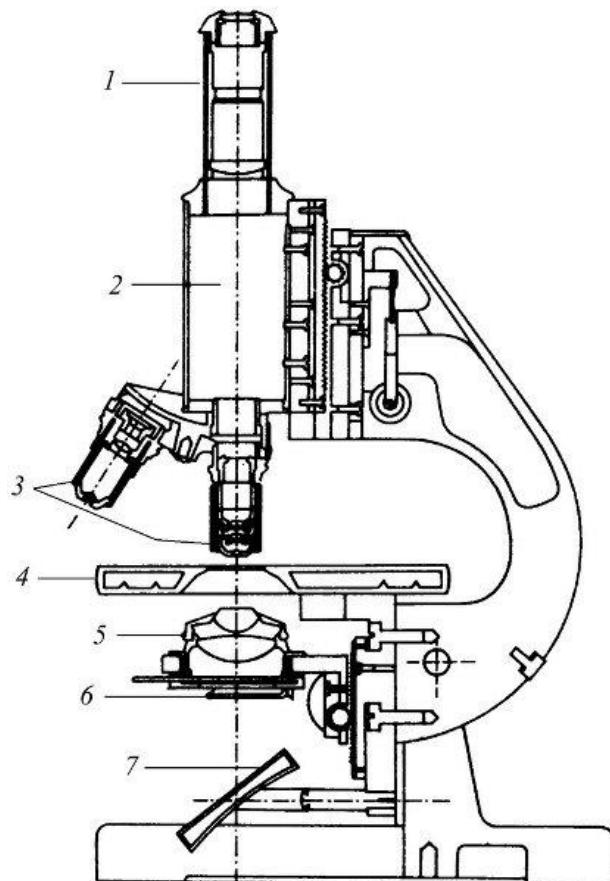
Slika 30. Shematski prikaz optičkog mikroskopa; 1- okular, 2- tubus, 3- objektiv, 4- stolić, 5- kondenzor, 6- dijafragma, 7- zrcalo [81]
