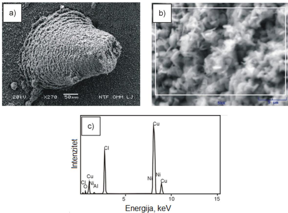
Slika 97. SEM mikrografija CuAlNi slitine nakon potenciodinamičkih ispitivanja – uzorak lijevanog stanja (a), povećani dio ispitana EDS analizom (b) i pripadajući EDS spektar (c)
