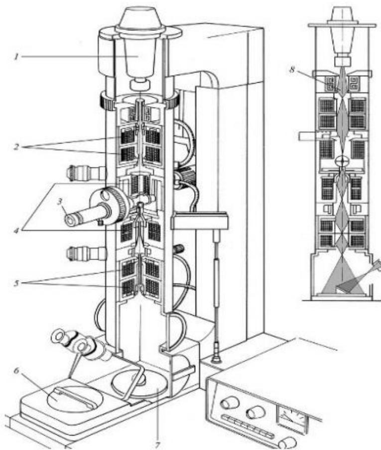
Slika 33. Transmisijski elektronski mikroskop, presjek uređaja (lijevo); put elektronskog snopa (desno); 1- elektronski top, 2- kondenzorske leće, 3- zapornica za umetanje uzorka, 4- leća objektiva, 5- projektorska leća, 6- kamera, 7- fluorescentni zaslon, 8- elektronski sklop [87]
