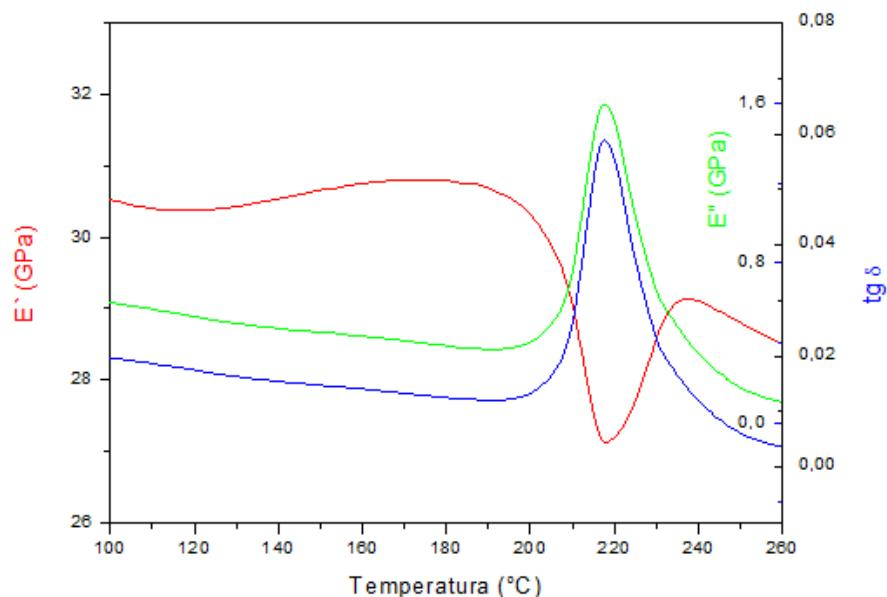
Slika 75. DMA spektar CuAlNi slitine s prisjetljivošću oblika nakon kaljenja  $885\text{ }^{\circ}\text{C}/60'\text{/H}_2\text{O}$
