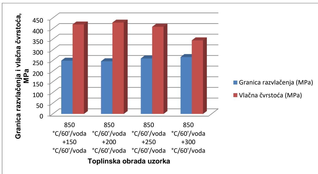
Slika 110. Utjecaj temperature popuštanja nakon kaljenja 850 °C/60'/H<sub>2</sub>O na granicu razvlačenja i vlačnu čvrstoću CuAlNi slitine s prisjetljivošću oblika
