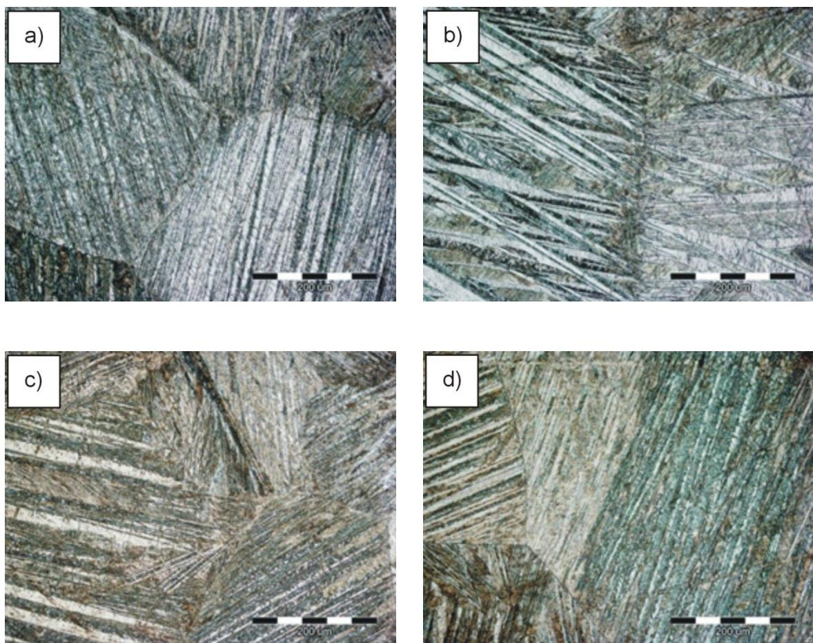
Slika 53. Optičke mikrografije CuAlNi slitine s prisjetljivošću oblika nakon kaljenja
