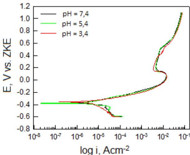
Slika 91. Usporedni prikaz potenciodinamičkih polarizacijskih krivulja za toplinski obrađenu CuAlNi slitinu (885 °C/60'/H<sub>2</sub>O) pri različitim pH vrijednostima otopine
