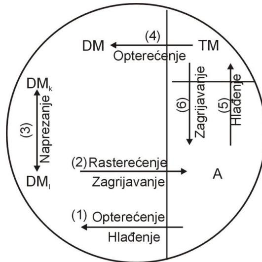
Slika 2. Shematski prikaz šest faznih transformacija slitina s prisjetljivošću oblika; A – austenit, TM – samoprilagođavajući martenzit, DM – naprezanjem inducirani martenzit,  $DM_k$  – naprezanjem inducirani martenzit (varijanta k) i  $DM_l$  – naprezanjem inducirani martenzit (varijanta l) [25]
