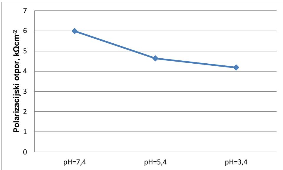
Slika 118. Utjecaj pH otopine na vrijednost polarizacijskog otpora
