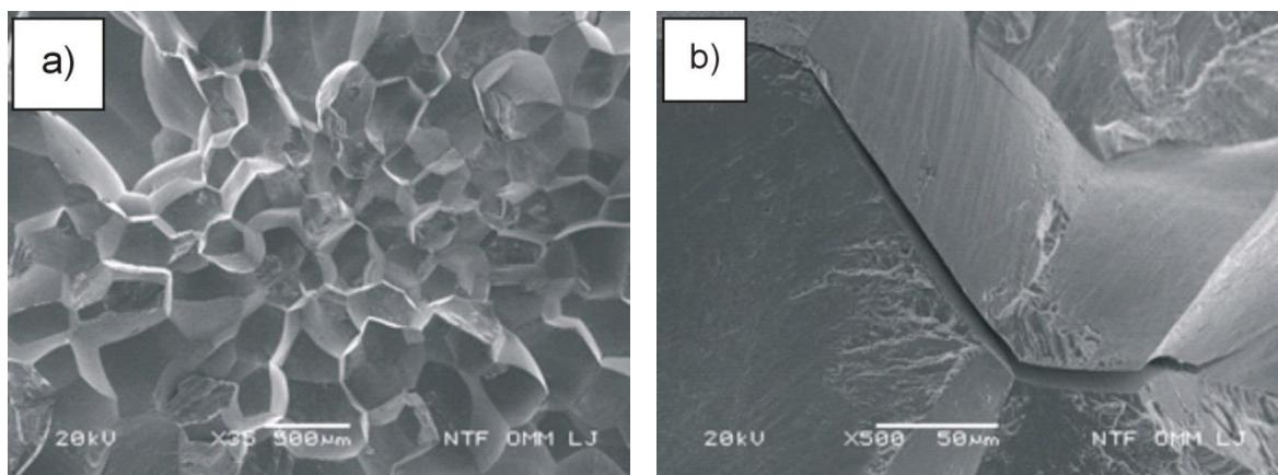
Slika 82. Mikrofraktografije CuAlNi slitine nakon kaljenja  $885\text{ }^{\circ}\text{C}/60'\text{/H}_2\text{O}$  i
