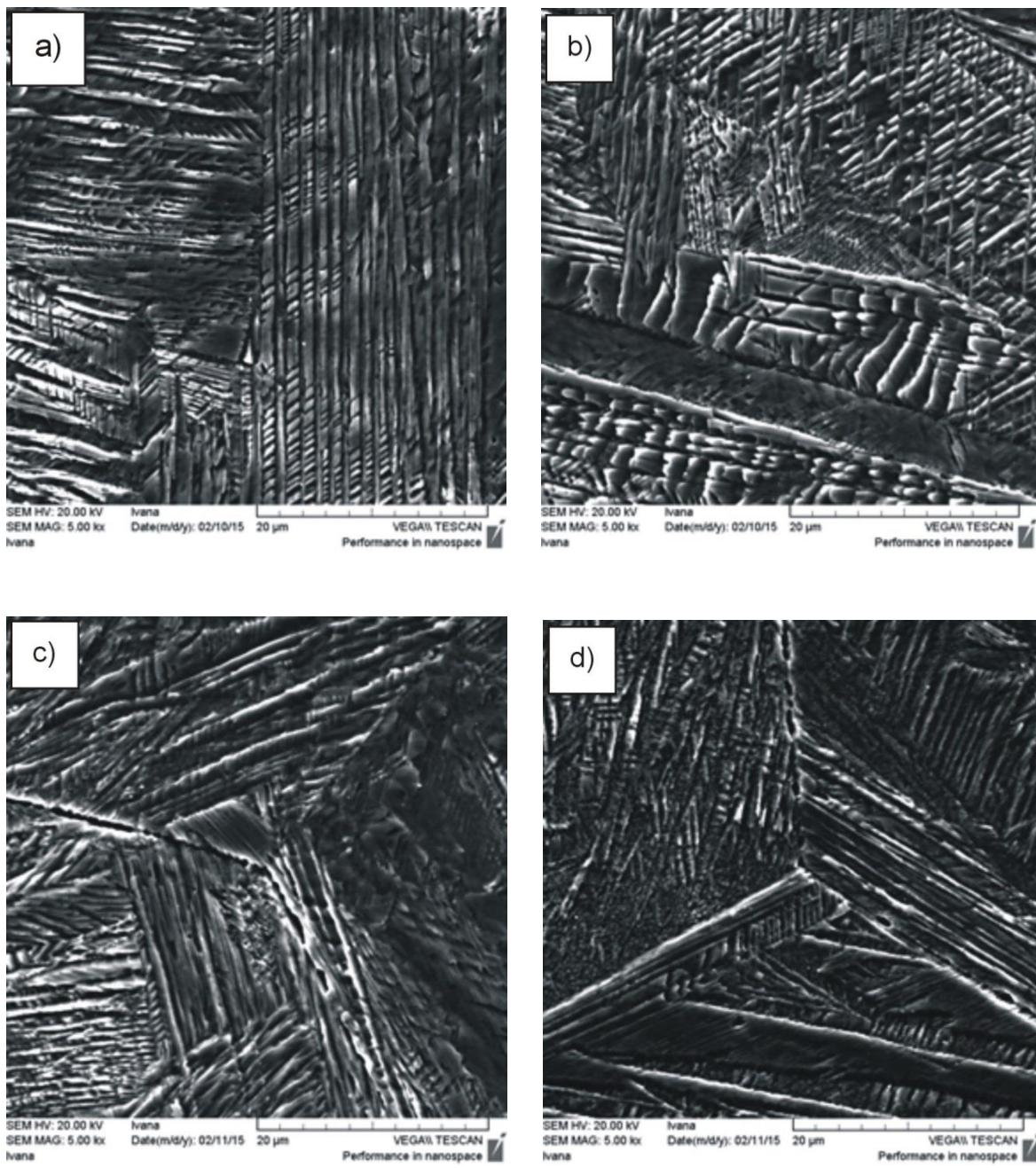
Slika 62. SEM mikrografije CuAlNi slitine s prisjetljivošću oblika nakon kaljenja
