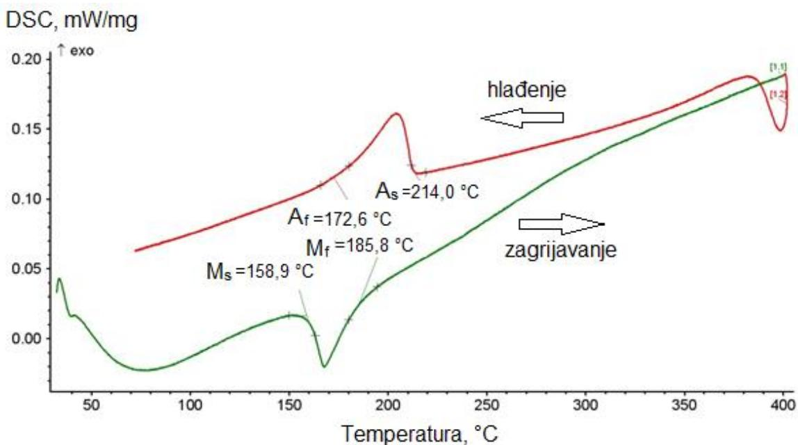
Slika 69. DSC krivulje CuAlNi slitine nakon kaljenja  $920 \text{ } ^\circ\text{C}/60'/\text{H}_2\text{O}$
