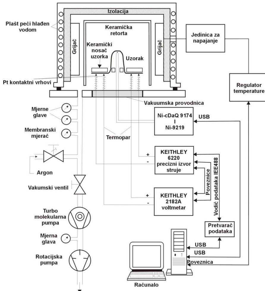
Slika 38. Shematski prikaz mjernog sustava za mjerjenje električnog otpora [93]
