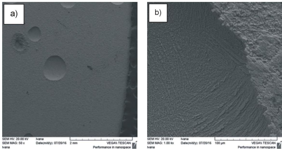
Slika 102. SEM mikrografije površine uzorka CuAlNi slitine nakon potenciodinamičkog polarizacijskog mjerena u 1,5 % NaCl otopini nakon ultrazvučnog čišćenja korozijskog produkta; a – 50x, b – 1000x
