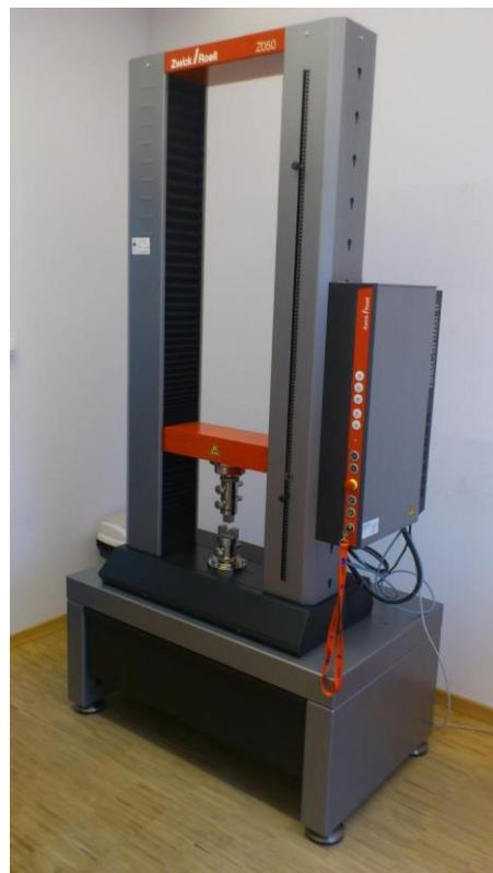
Slika 40. Fotografija kidalice Zwick/Roell Z050
