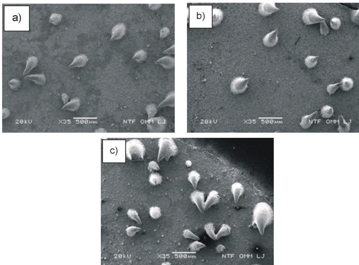
Slika 100. SEM mikrografije koroziskih produkata nakon potenciodinamičkog polarizacijskog ispitivanja u 0,9 % NaCl otopini pri pH = 7,4 (a), pH = 5,4 (b) i pH = 3,4 (c)
