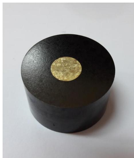
Slika 27. Fotografija uzorka pripremljenog za mikrostrukturnu analizu
