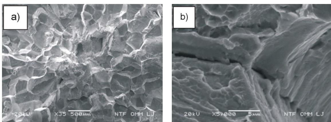
Slika 79. Mikrofraktografije CuAlNi slitine nakon kaljenja  $850\text{ }^{\circ}\text{C}/60'\text{/H}_2\text{O}$  i
