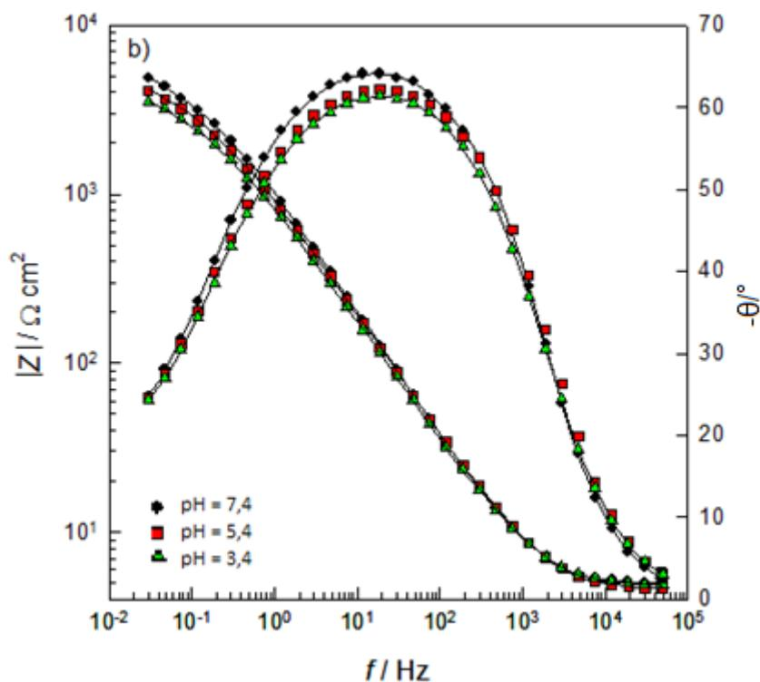
Slika 92. Nyquistov (a) i Bodeov (b) prikaz za CuAlNi slitinu kaljeno stanje  $885^\circ\text{C}/60'/\text{H}_2\text{O}$  u 0.9% NaCl otopini pri  $T = 37^\circ\text{C}$  i različitim pH vrijednostima otopine
