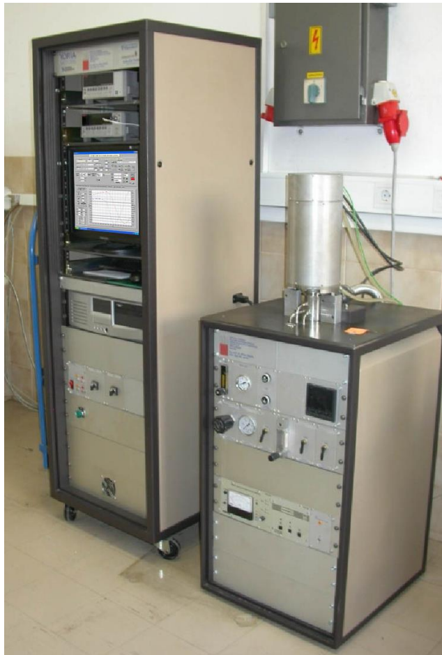
Slika 37. Fotografija aparature za mjerenje električnog otpora uzoraka
