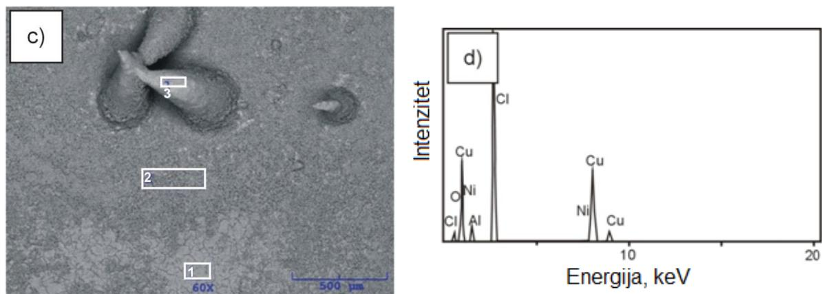
Slika 98. SEM mikrografija CuAlNi slitine nakon potenciodinamičkih ispitivanja – uzorak kaljen  $850\text{ }^{\circ}\text{C}/60'\text{/H}_2\text{O}$  (a), povećani dio površine uzorka (b), pozicije označene za ispitivanje EDS analizom (c) i pripadajući EDS spektar pozicije 1 (d)
