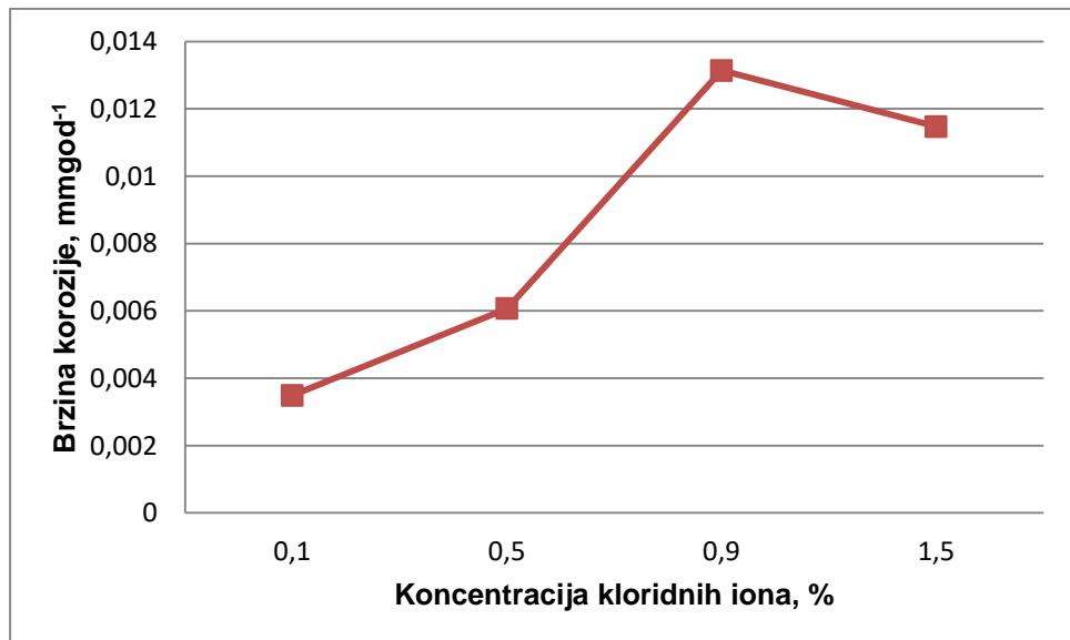
Slika 121. Utjecaj koncentracije kloridnih iona na brzinu korozije
