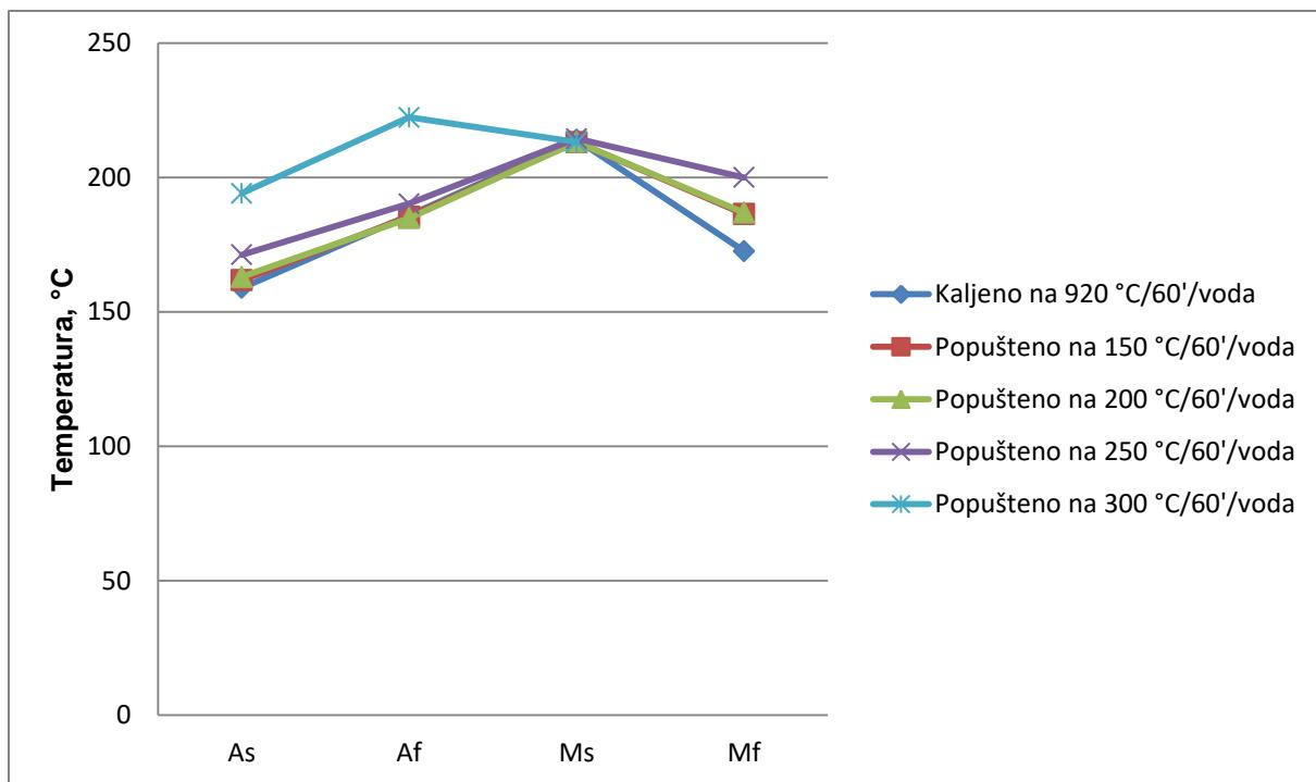
Slika 107. Utjecaj toplinske obrade na temperature faznih transformacija CuAlNi slitine nakon kaljenja 920 °C/60'/H<sub>2</sub>O i popuštanja
