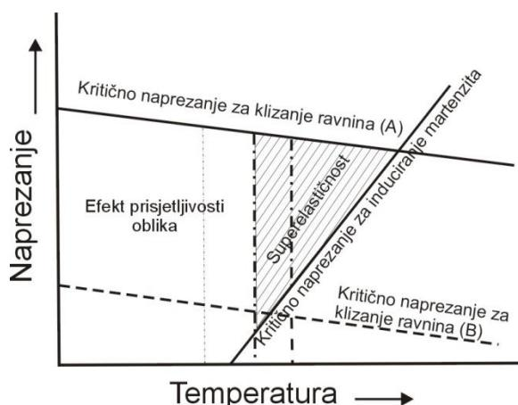
Slika 12. Shematski prikaz područja efekta prisjetljivosti oblika i superelastičnosti u ovisnosti o temperaturi i naprezanju [6]
