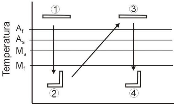
Slika 10. Shematski prikaz dvosmjernog efekta prisjetljivosti oblika [3]
