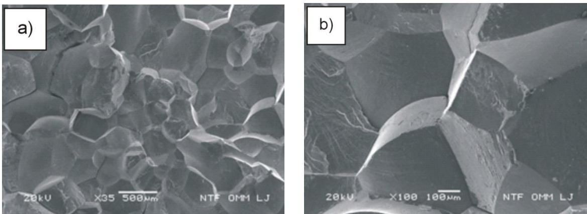
Slika 84. Mikrofraktografije CuAlNi slitine nakon kaljenja 920 °C/60'/H<sub>2</sub>O i popuštanja 300 °C/60'/H<sub>2</sub>O; povećanje: a – 35x, b – 100x
