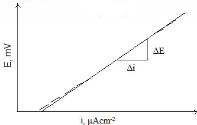
Slika 45. Određivanje polarizacijskog otpora iz nagiba polarizacijske krivulje u blizini koroziskog potencijala [97]
