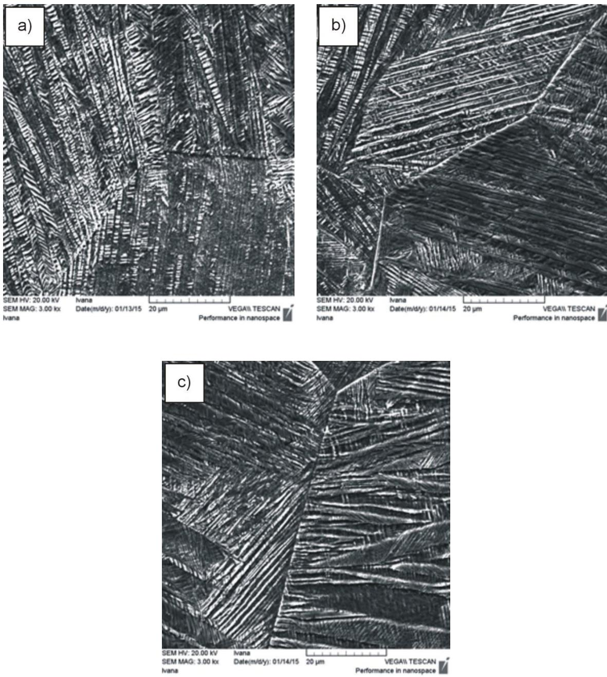
Slika 57. SEM mikrografije CuAlNi slitine s prisjetljivošću oblika u kaljenom stanju; 850 °C/60'/ H<sub>2</sub>O (a), 885 °C/60'/ H<sub>2</sub>O (b) i 920 °C/60'/ H<sub>2</sub>O (c)
