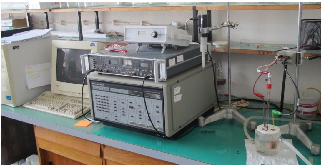
Slika 44. Aparatura za provedbu elektrokemijskih ispitivanja
