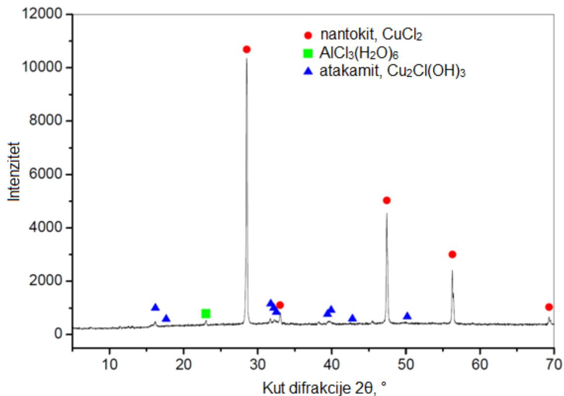
Slika 122. Rezultati XRD analize površinskih korozijskih produkata
