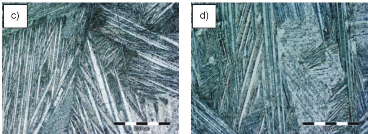
Slika 52. Optičke mikrografije CuAlNi slitine s prisjetljivošću oblika nakon kaljenja
