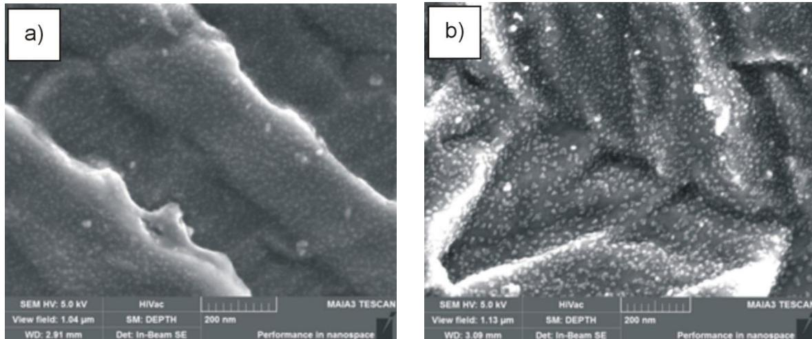
Slika 59. SEM mikrografije CuAlNi slitine s prisjetljivošću oblika u lijevanom (a) i kaljenom stanju  $850\text{ }^{\circ}\text{C}/60'$   $\text{H}_2\text{O}$  (b), pri velikim povećanjima 260000x (a) i 240000x (b)
