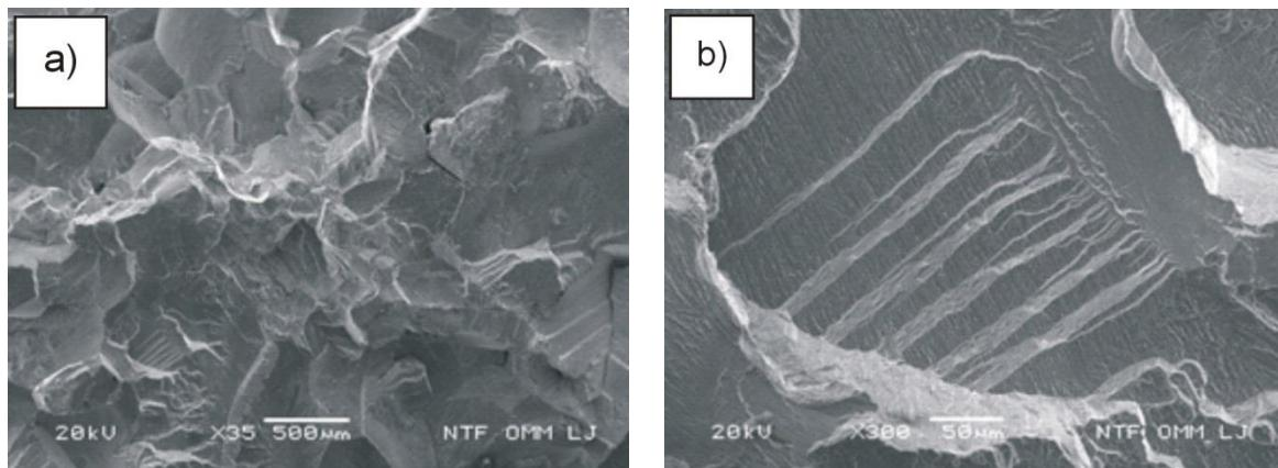
Slika 78. Mikrofraktografije CuAlNi slitine nakon kaljenja  $920\text{ }^{\circ}\text{C}/60'\text{/H}_2\text{O}$ ;
