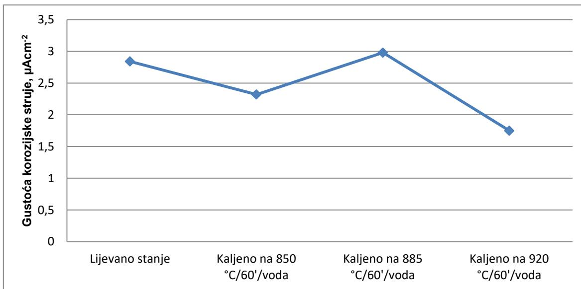
Slika 115. Utjecaj temperature kaljenja na vrijednost gustoće koroziske struje
