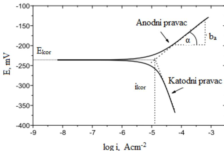
Slika 46. Tafelova metoda određivanja korozijskih parametara iz polarizacijskih mjerena [70]
