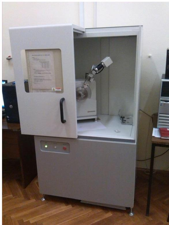
Slika 29. Fotografija difraktometra Shimadzu XRD-6000
