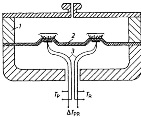
Slika 35. Shematski prikaz čelije DSC instrumenta baziranog na principu toplinskog toka: 1 – peć, 2 – postolje za posudice s ispitivanim i referentnim uzorkom, 3 – termoparovi,  $T_P$  – temperatura ispitivanog uzorka,  $T_R$  – temperatura referentnog uzorka,  $\Delta T_{PR}$  – razlika temperatura ispitivanog i referentnog uzorka [91]
