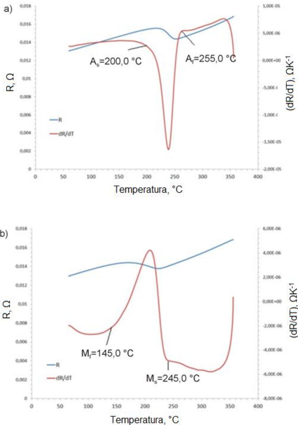
Slika 70. Krivulja zagrijavanja (a) i hlađenja (b) dobivena mjerjenjem električnog otpora CuAlNi slitine u lijevanom stanju
