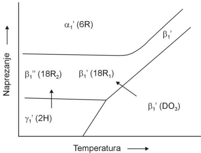
Slika 15. Shematski fazni dijagram CuAlNi slitine
