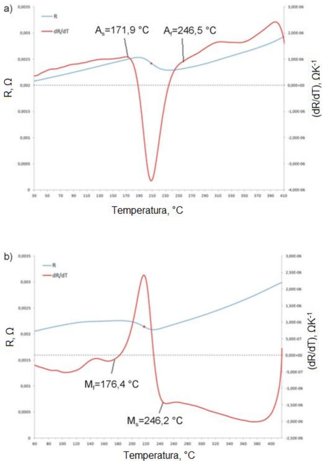
Slika 72. Krivulja zagrijavanja (a) i hlađenja (b) dobivena mjerjenjem električnog otpora CuAlNi slitine nakon kaljenja  $885 \text{ } ^\circ\text{C}/60'/\text{H}_2\text{O}$  i popuštanja  $300 \text{ } ^\circ\text{C}/60'/\text{H}_2\text{O}$
