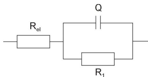
Slika 49. Ekvivalentni električni krug za sustav metal/pasivni sloj/otopina [86]
