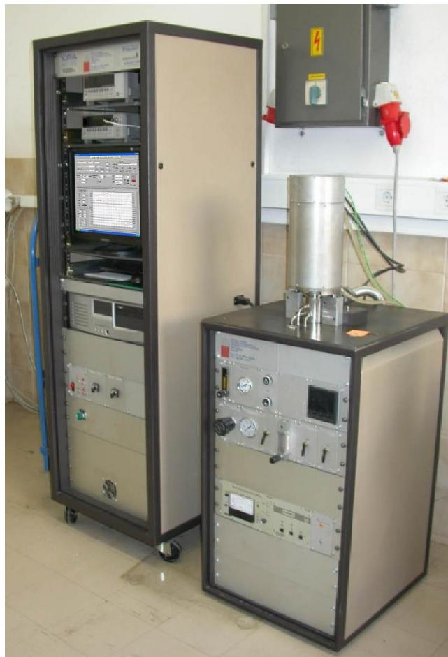
Slika 37. Fotografija aparature za mjerjenje električnog otpora uzorka
