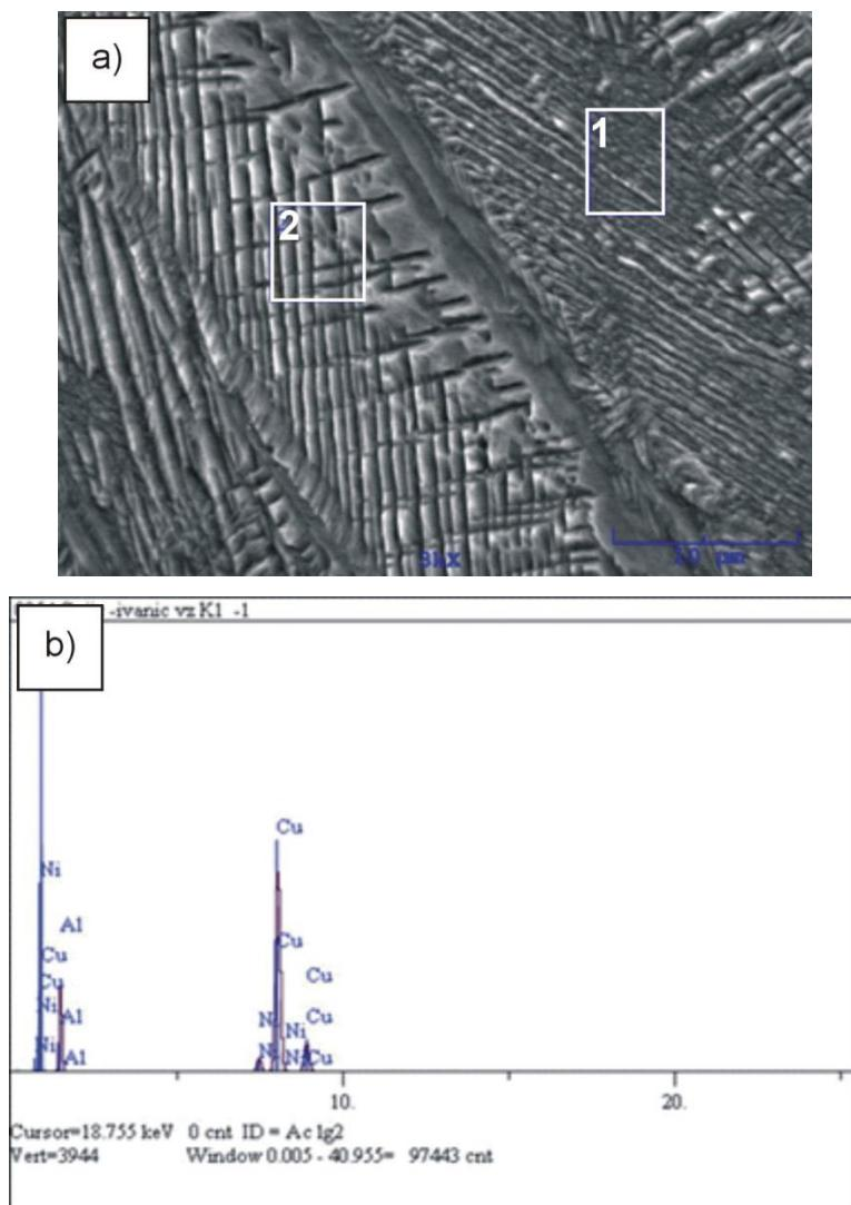
Slika 58. SEM mikrografija CuAlNi slitine s prisjetljivošću oblika u kaljenom stanju
