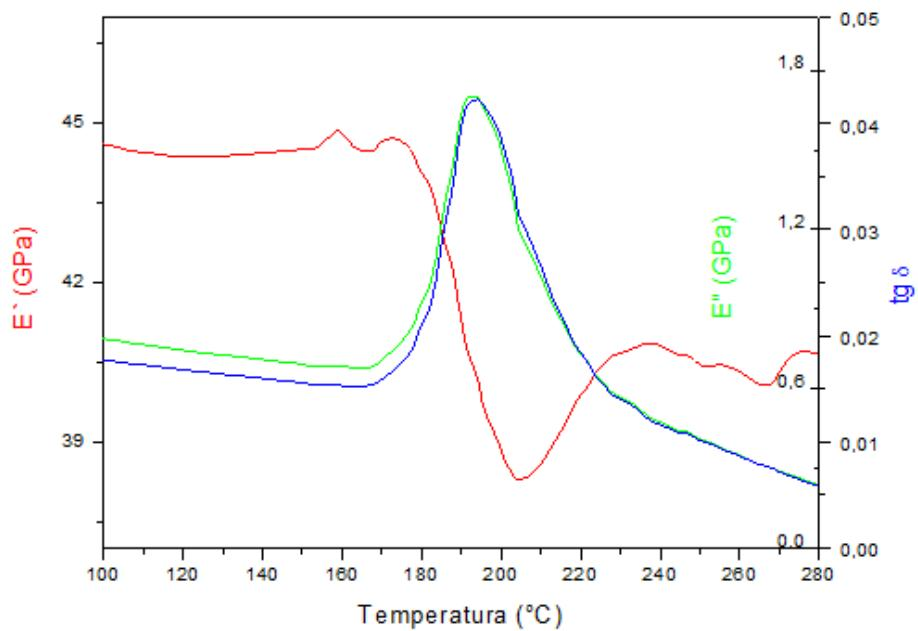
Slika 74. DMA spektar CuAlNi slitine s prisjetljivošću oblika nakon kaljenja  $885\text{ }^{\circ}\text{C}/60'\text{/H}_2\text{O}$
