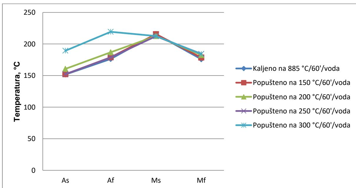
Slika 106. Utjecaj toplinske obrade na temperature faznih transformacija CuAlNi slitine nakon kaljenja  $885\text{ }^{\circ}\text{C}/60'\text{/H}_2\text{O}$  i popuštanja
