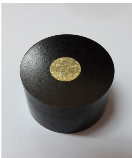
Slika 27. Fotografija uzorka pripremljenog za mikrostrukturnu analizu
