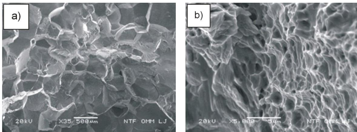
Slika 81. Mikrofraktografije CuAlNi slitine nakon kaljenja  $885\text{ }^{\circ}\text{C}/60'\text{/H}_2\text{O}$  i
