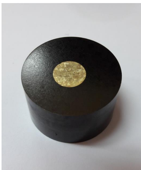
Slika 27. Fotografija uzorka pripremljenog za mikrostrukturnu analizu
