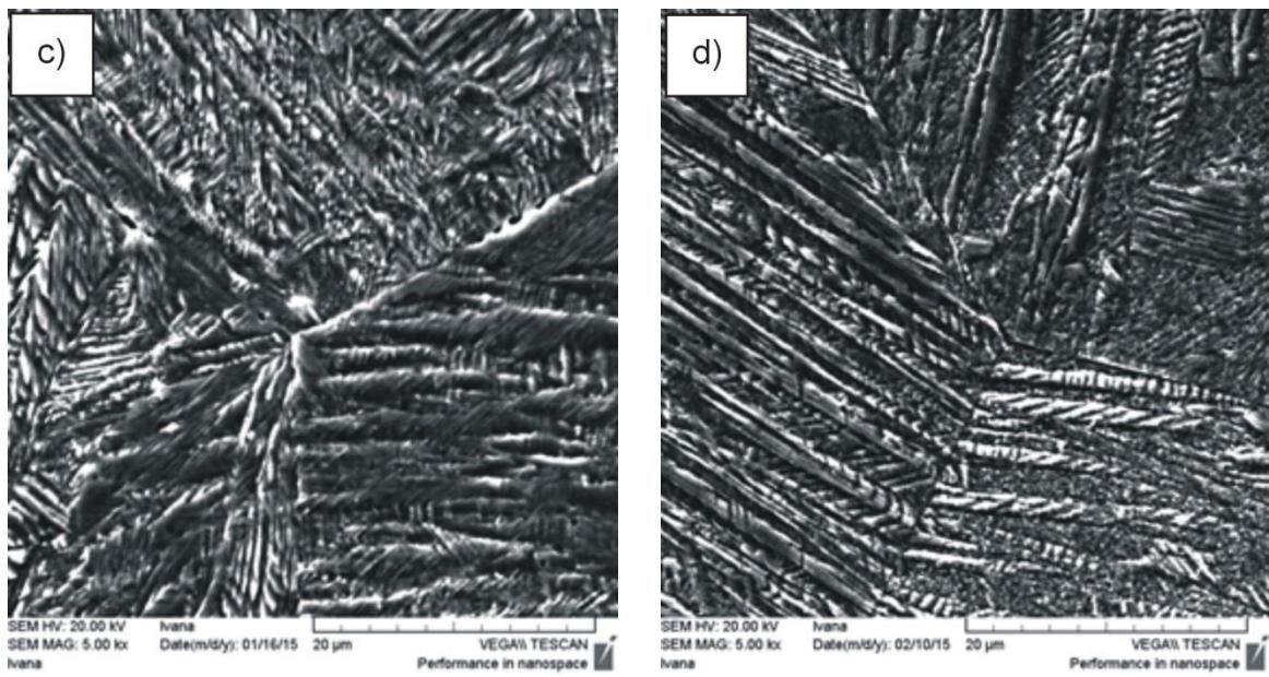
Slika 60. SEM mikrografije CuAlNi slitine s prisjetljivošću oblika nakon kaljenja
