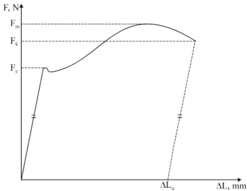
Slika 41. Dijagram sila  $F$  - produljenje  $\Delta L$  [96]
