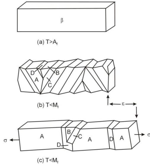
Slika 5. Shematski prikaz kristala  $\beta$  faze (a), spontano nastali martenzit, dvojnikovanje A, B, C i D varijanti nakon hlađenja i transformacije u martenzit (b), varijanta A je dominantna nakon podvrgavanja naprezanju (c) [1, 5]
