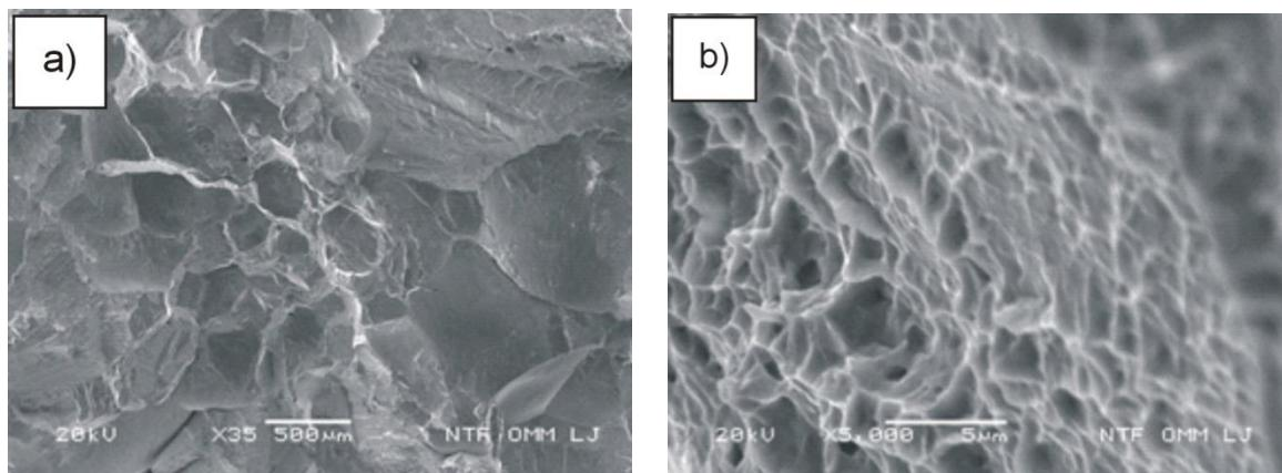
Slika 77. Mikrofraktografije CuAlNi slitine nakon kaljenja  $885\text{ }^{\circ}\text{C}/60'\text{/H}_2\text{O}$ ;
