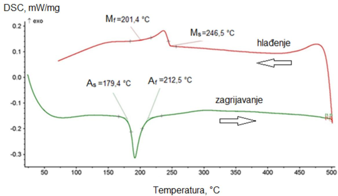
Slika 66. DSC krivulje CuAlNi slitine nakon lijevanja
