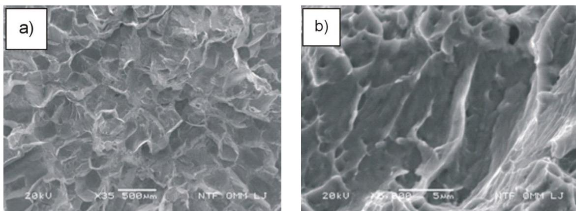
Slika 76. Mikrofraktografije CuAlNi slitine nakon kaljenja 850 °C/60'/H<sub>2</sub>O;
