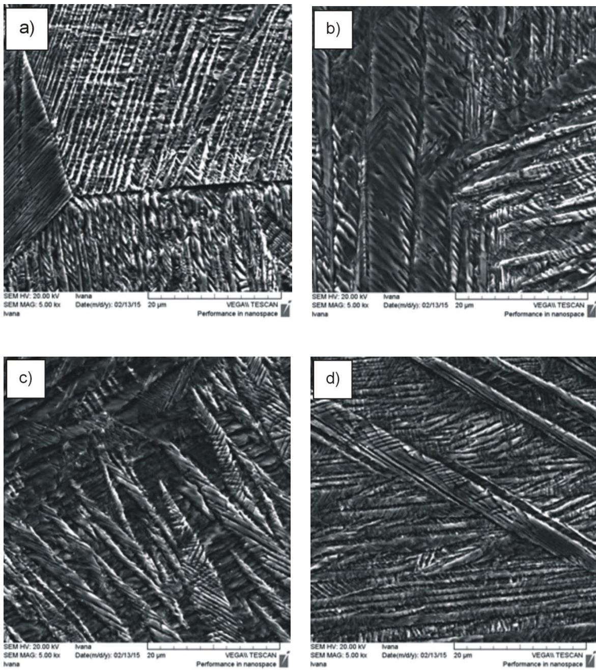
Slika 63. SEM mikrografije CuAlNi slitine s prisjetljivošću oblika nakon kaljenja
