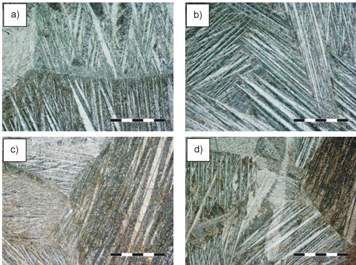
Slika 54. Optičke mikrografije CuAlNi slitine s prisjetljivošću oblika nakon kaljenja
