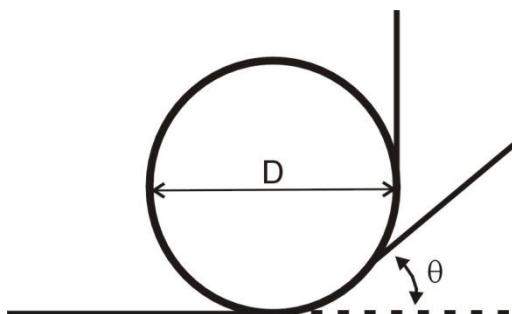
Slika 8. Shematski prikaz mjerjenja efekta prisjetljivosti oblika [30]
