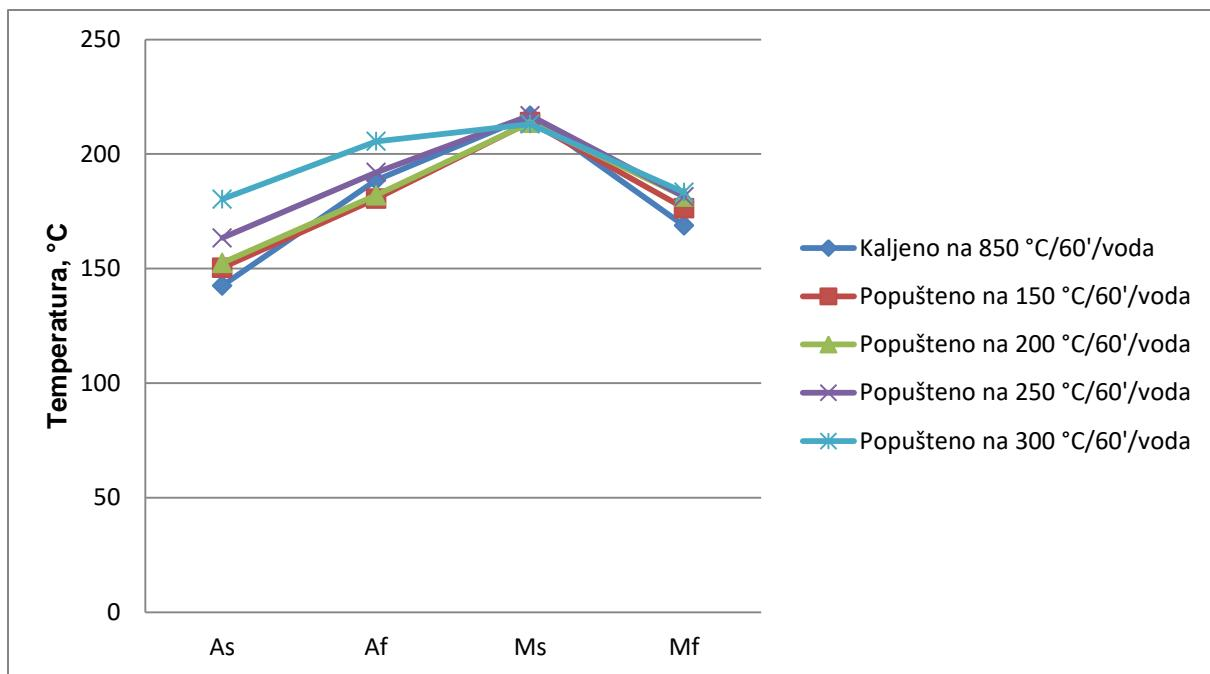
Slika 105. Utjecaj toplinske obrade na temperature faznih transformacija CuAlNi slitine nakon kaljenja  $850\text{ }^{\circ}\text{C}/60'\text{/H}_2\text{O}$  i popuštanja
