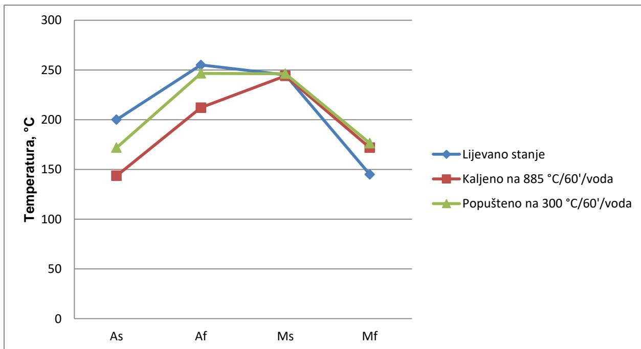
Slika 108. Utjecaj kaljenja i popuštanja na temperature faznih transformacija – ispitivanja provedena metodom mjerjenja električnog otpora
