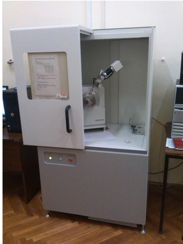
Slika 29. Fotografija difraktometra Shimadzu XRD-6000
