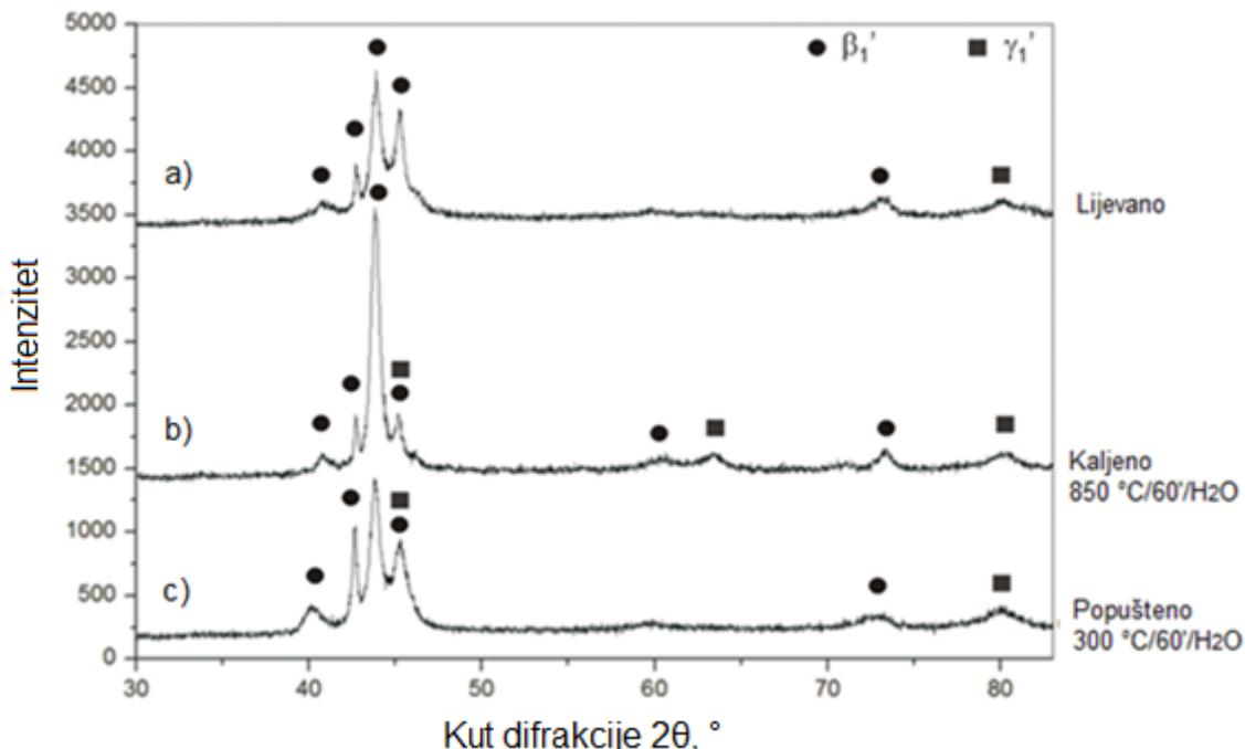
Slika 65. XRD rendgenografi CuAlNi slitina s prisjetljivošću oblika u lijevanom stanju (a), kaljenom stanju 850 °C/60'/H<sub>2</sub>O (b) i popuštenom stanju 300 °C/60'/H<sub>2</sub>O (c)
