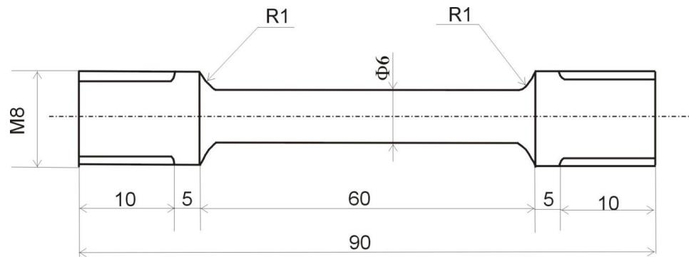
Slika 39. Shematski prikaz epruvete za mehanička ispitivanja
