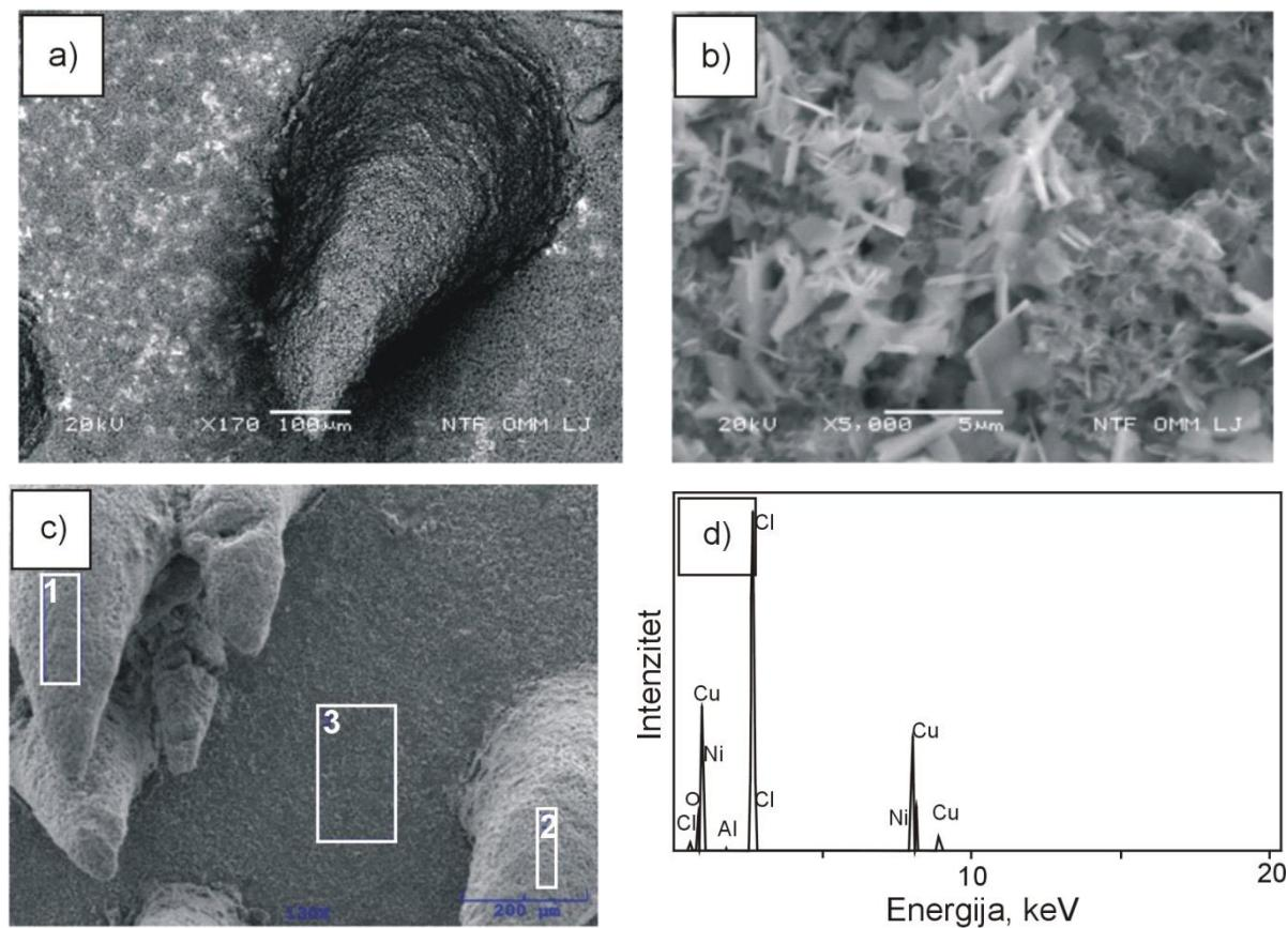
Slika 99. SEM mikrografija CuAlNi slitine nakon potenciodinamičkih ispitivanja – uzorak kaljen  $920\text{ }^{\circ}\text{C}/60'\text{/H}_2\text{O}$  (a), povećana površina koroziskog produkta (b), pozicije označene za ispitivanje EDS analizom (c) i pripadajući EDS spektar pozicije 1 (d)
