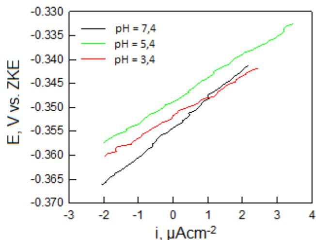
Slika 90. Usporedni prikaz linearnih dijelova krivulje linearne polarizacije za toplinski obrađenu CuAlNi slitinu (885 °C/60'/H<sub>2</sub>O) pri različitim pH vrijednostima otopine
