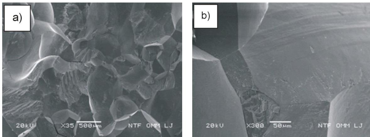
Slika 80. Mikrofraktografije CuAlNi slitine nakon kaljenja  $850\text{ }^{\circ}\text{C}/60'\text{/H}_2\text{O}$  i
