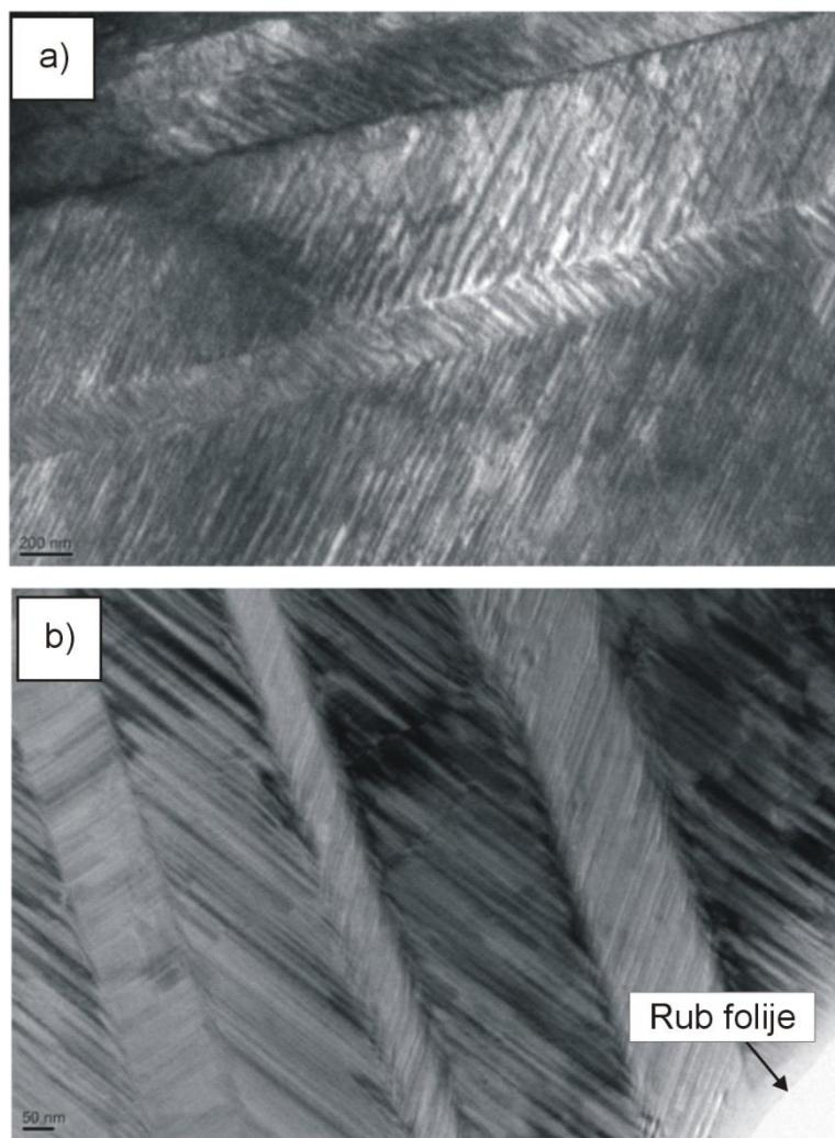
Slika 64. TEM mikrografije uzorka CuAlNi slitine u lijevanom stanju (a) i kaljenom stanju ( $920\text{ }^{\circ}\text{C}/60'\text{/H}_2\text{O}$ ) (b), svijetlo polje
