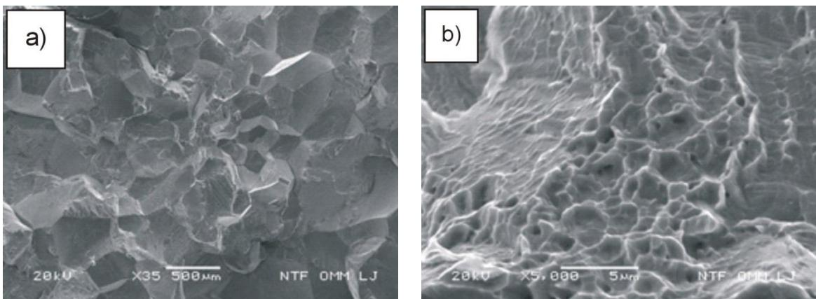
Slika 83. Mikrofraktografije CuAlNi slitine nakon kaljenja 920 °C/60'/H<sub>2</sub>O i popuštanja 150 °C/60'/H<sub>2</sub>O; povećanje: a – 35x, b – 5000x
